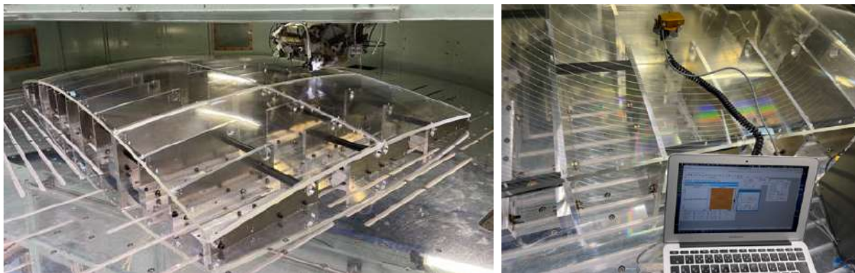
Рис. 1.28: Слева: процесс формирования линзы. Справа: тестирование качества френелевской структуры линзы.
