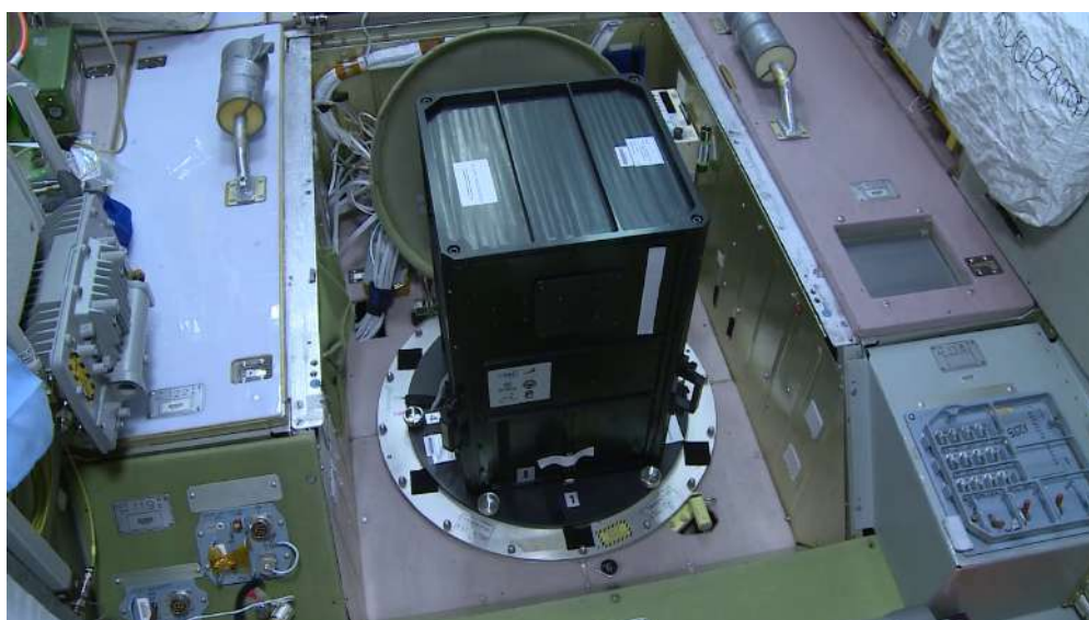
Рис. 1.24: «УФ атмосфера» внутри МКС на УФ-прозрачном окне модуля «Звезда». Направление обзора – в надир; нижняя центральная часть (обозначенная «1») ориентирована по направлению вектора скорости станции.
