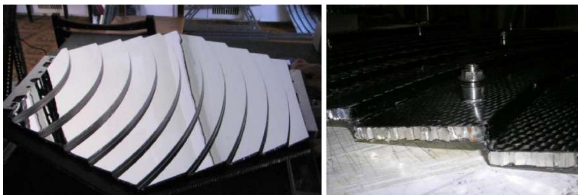
Рис. 1.7: Боковой сегмент зеркала-концентратора (слева) и его трехслойная структура (справа).
