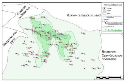
Рисунок 13. Схема суммарного долевого участия интервалов относительно высокоемких коллекторов в разрезе фаменского циклита.
