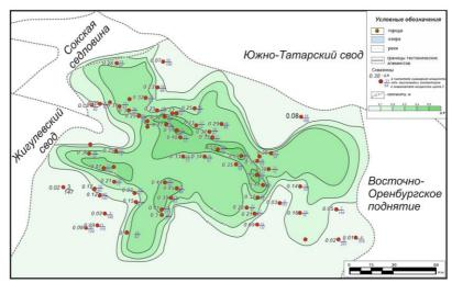
Рисунок 12. Схема суммарного долевого участия интервалов относительно высокоемких коллекторов в разрезе верхнефранского циклита.
