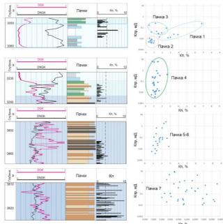
Рисунок 8. Распределение пачек в разрезе скважин и графики зависимости коэффициента открытой пористости и абсолютной проницаемости по газу для разных пачек пород. Условные обозначения на рисунке 3.
