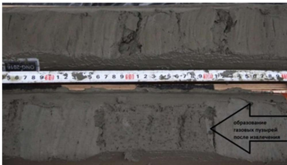
*Рис.90 Образец керна, отобранного в области сфокусированной разгрузки газа. Наблюдается образование газовых пузырей.*
