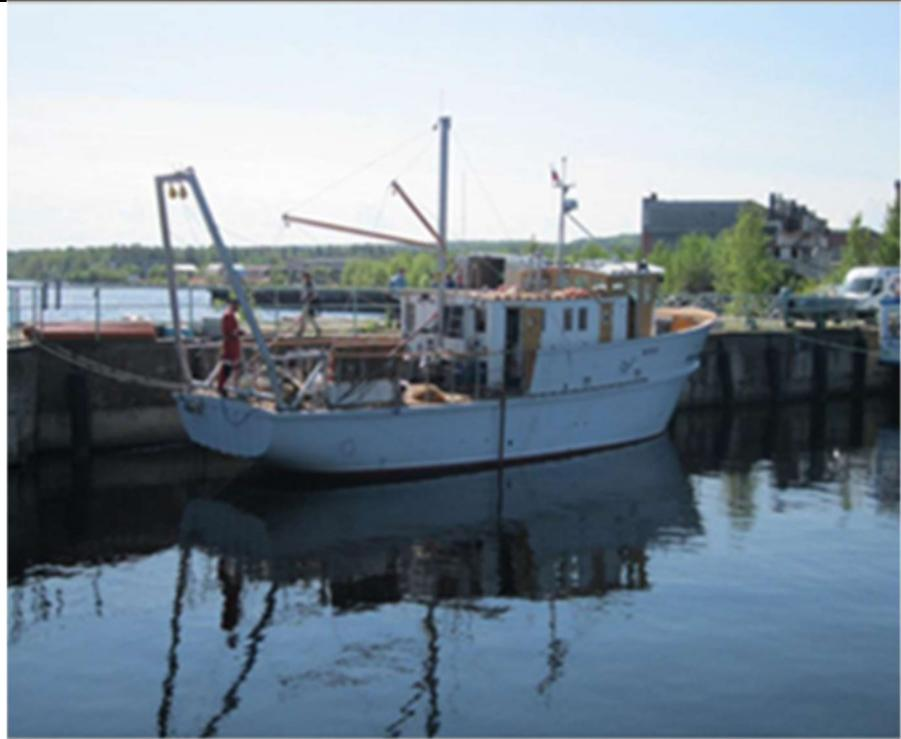
Данные 2015 г. были получены с борта НИС «Эколог». Основной объем работ был запланирован на акватории Ладожского озера, однако ОМР производились на акватории Петрозаводской губы. На штанге по правому борту был закреплен гидролокатор бокового обзора StarFish, а в кормовой части на выдвигной 3 м штанге буксировались пресноводный электроискровой излучатель (100 электродов в контейнере), одноканальная и многоканальная сейсмокоды.
