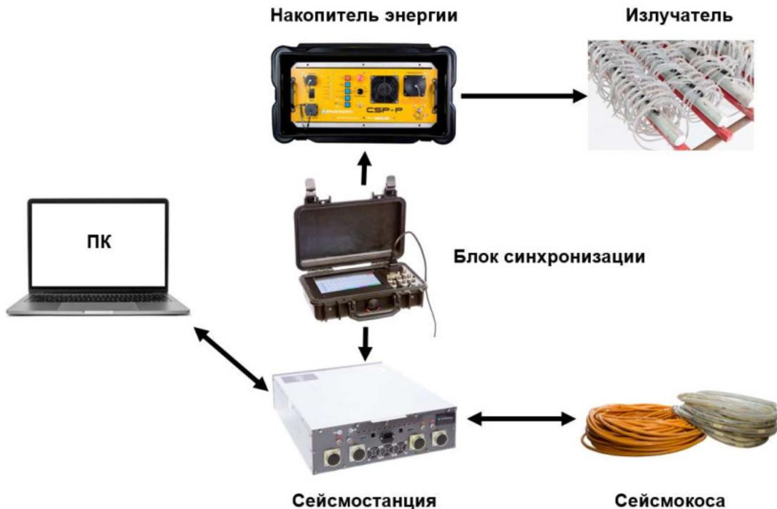
Рисунок 9. Схема сейсмического канала, использовавшегося для проведения полевых испытаний.
