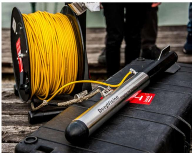
*Рис.3 Пример компактного комплекта гидролокации бокового обзора, буксируемого за судном на кабель-тросе.*
