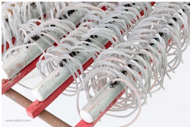
*Рис.1. Внешний вид одного из вариантов конструкции электроискрового излучателя SplitMultiSeis. При работе на пресноводных акваториях излучающие секции помещаются в контейнер, наполненный солевым раствором.*
