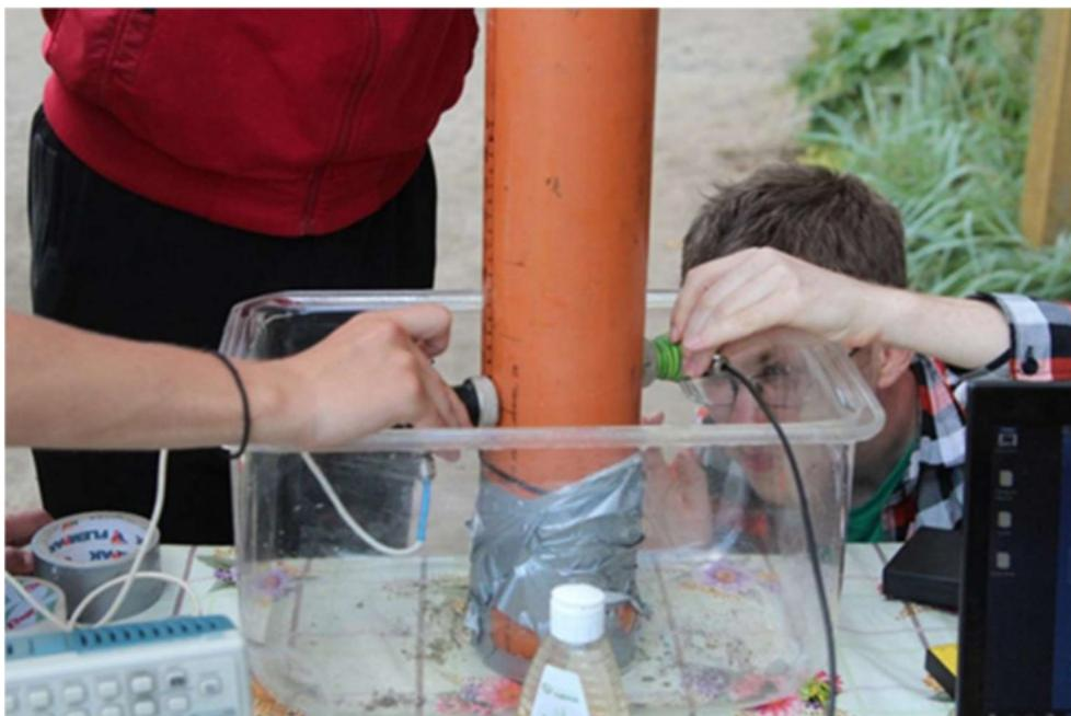
Рис.21 Фото процесса проведения измерений акустических свойств на трубке.
