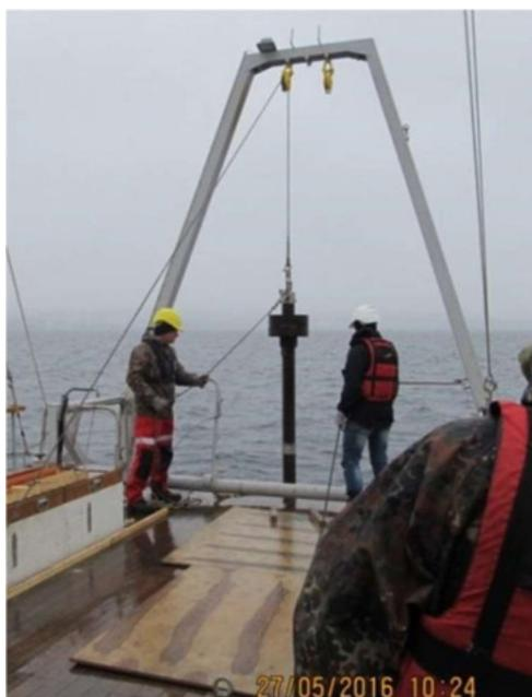
*Рис.17 Процедура спуско-подъемных работ с геологическим пробоотборником.*
