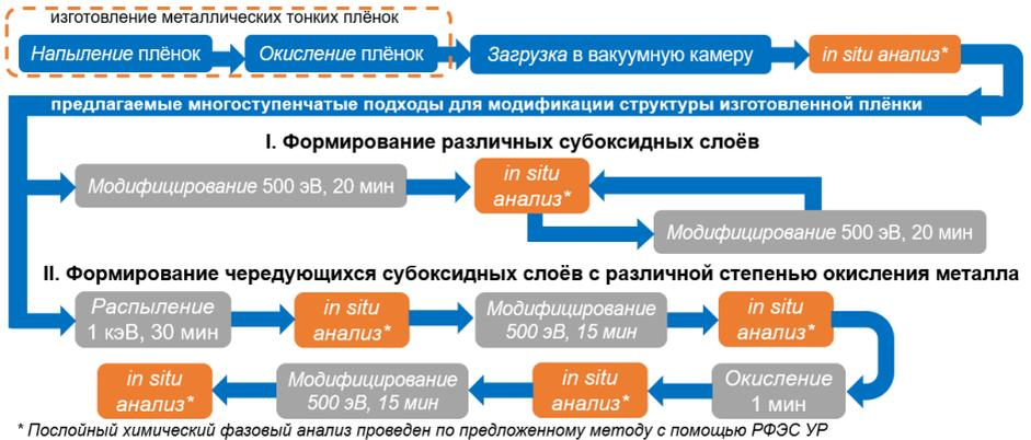
Рисунок 5. Этапы изготовления окисленных ниобиевых тонких пленок и последовательность режимов воздействия
