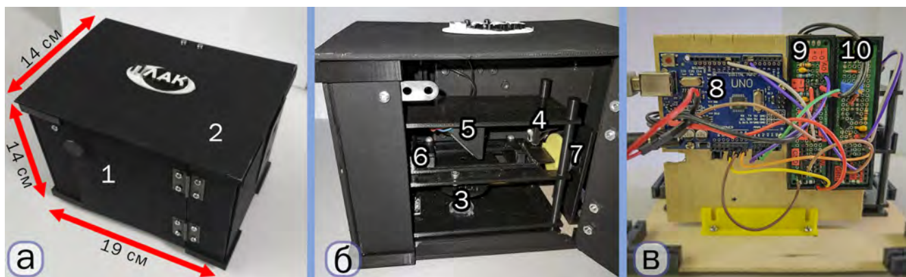
Рис. 44: Агрегометр модели «ПЛАК 1»: (а) с внешним корпусом, на котором находится (1) открывающаяся дверка и (2) крышка; (б) с открытой дверкой, через которую видны (3) – основной фотодиод, (4) – референсный фотодиод, (5) – лазер, расположенный под светоделительной платиной, (6) – подложка под кювету, и (6) – вибродинамик; (в) задняя сторона агрегометра без внешнего корпуса, на которой виден (8) микроконтроллер Ардуино Uno R3, (9) плата с модулем для вибродинамика и модулем для фотодиодов и (10) плата с модулем для лазера.
