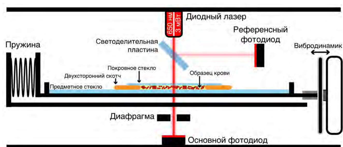
Рис. 41: Принципиальная схема портативного эритроцитарного агрегометра модели «ПЛАК 1». Лазерный пучок разделяется на два пучка: один пучок попадает на референсный фотодиод, а второй проходит через кювету с образцом крови и попадает на основной фотодиод. Вибродинамик позволяет создавать вибрации, индуцирующие дезагрегацию эритроцитов.
