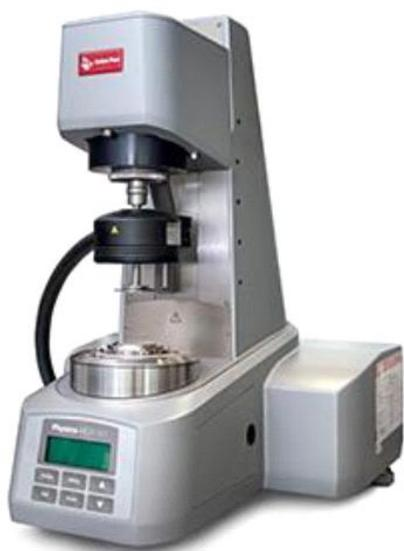
**Рисунок 2.5.** Реометр Anton Paar Physica MCR-301 (Австрия).
