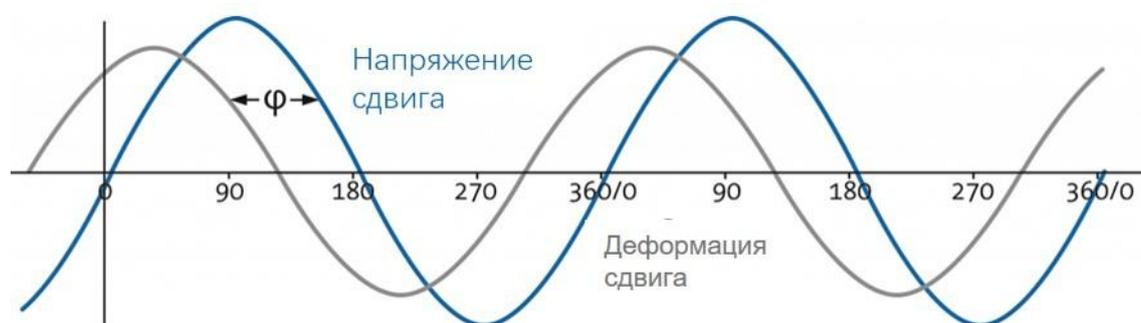
**Рисунок 2.9.** Изменение напряжения сдвига и деформации сдвига образца со временем при динамических измерениях.
