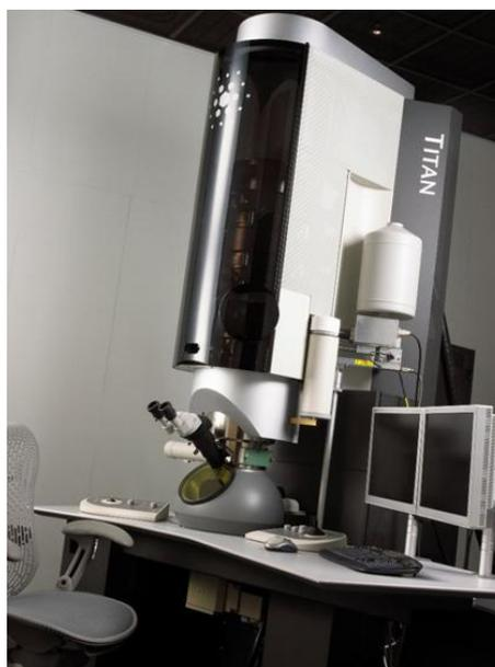
**Рисунок 2.11.** Электронный микроскоп Титан Криос 60-300.
