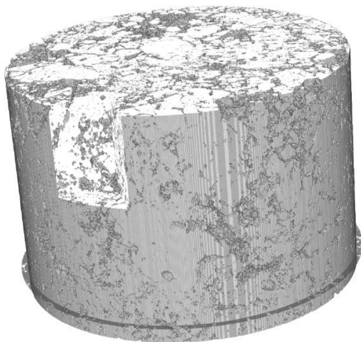
Рисунок 30. Цифровая воксельная модель почвенного монолита (разрешение 0.002 мм)
