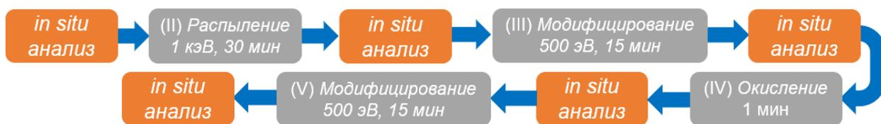
Рисунок 4.15. Этапы воздействия для формирования чередующихся субоксидных слоев с различной степенью окисления металла
