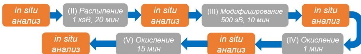
Рисунок 4.12. Этапы воздействия для формирования ультратонкого субоксидного слоя внутри слоя из высшего оксида
