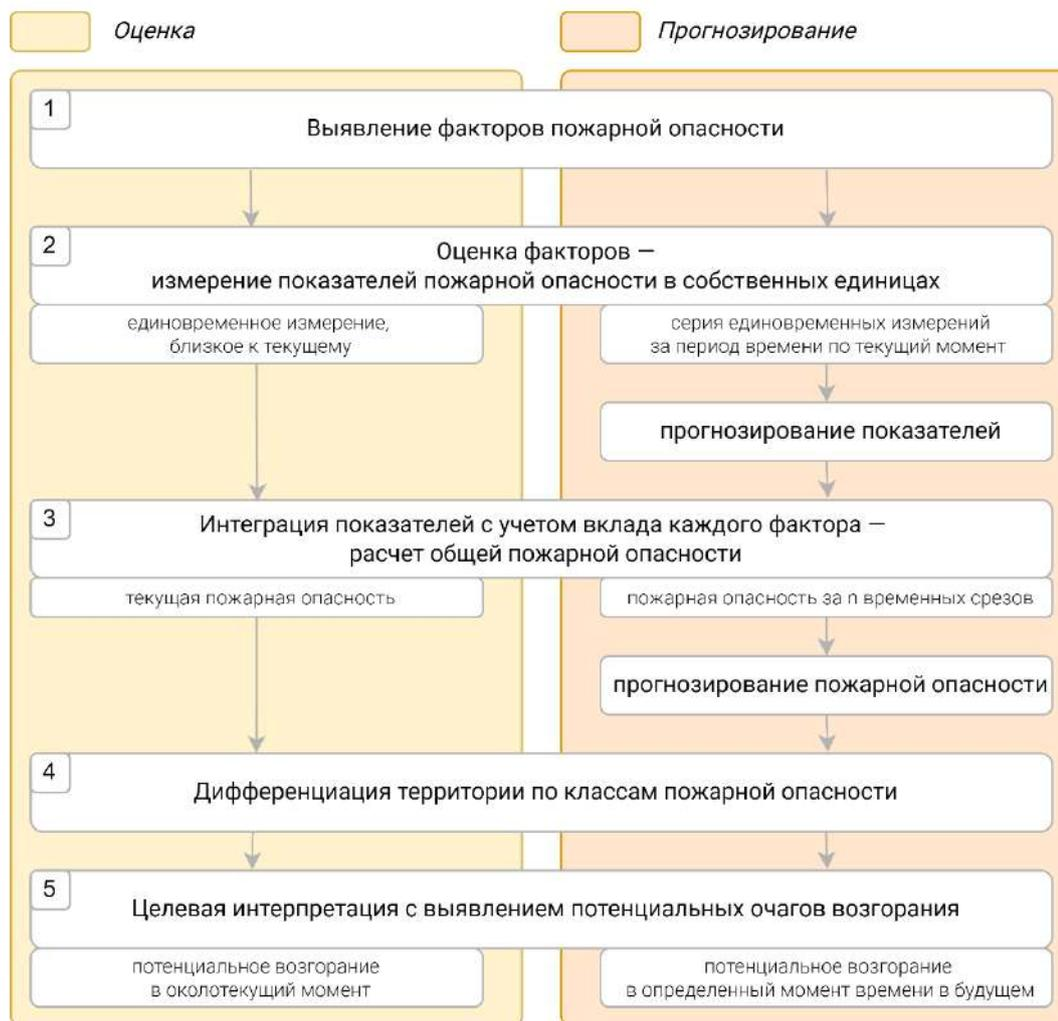
Рисунок 1.8. Базовая методическая последовательность моделирования пожарной опасности в целях оценки и прогнозирования
