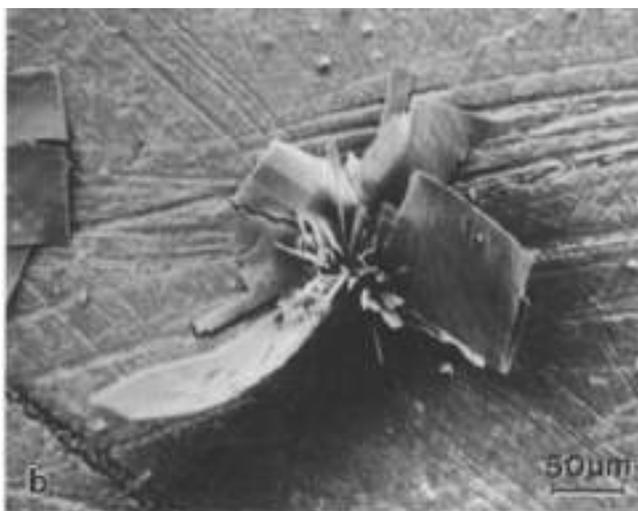
**Рисунок 5.** Кристалл  $\text{Ca}_x\text{OЭДФ}$  на поверхности кальцита.
