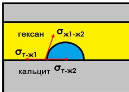
**Рисунок 16.** Схема эксперимента по избирательному смачиванию.
