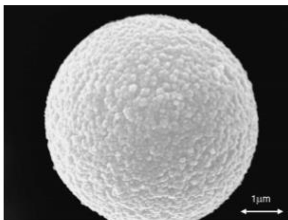
Рис. 7. Микрофотография полистирола, модифицированного наночастицами золота, полученная методом СЭМ [67].
