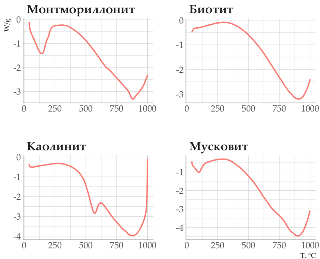
Рисунок 33. Кривые ДСК каолинита, монтмориллонита, мусковита, биотита.
