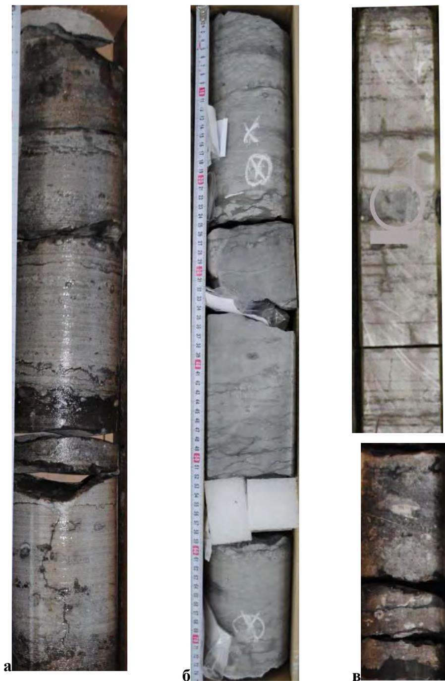
*Рисунок 24. Пример строения пачек 1-3 в полноразмерном керне а) Пачка 1 органические б) Пачка 2 известняки микрокристаллические в) Пачка 3 известняки органично-обломочные.*
