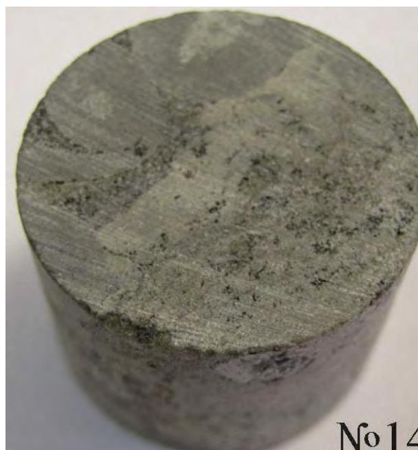
*Рисунок 53. Каверны в полноразмерном цилиндрическом образце.*
