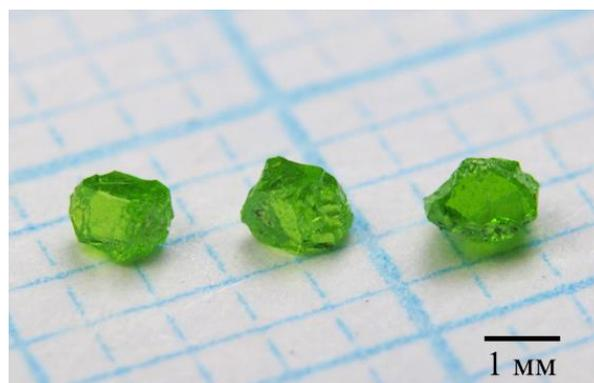
Рисунок 6.12. Фотография монокристаллов  $\text{Pr}_2\text{Mo}_2\text{O}_9$  под светодиодной лампой (5600 К).
