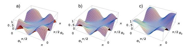
Рис. 3.17: ФУК для 2РDI криптона Kr рассчитанная для различных величин деполяризационного фактора h(J,J'): (a) - полностью перекрывающиеся подуровни промежуточного иона (LS-связь), (b) - частично перекрывающиеся, (c) - неперекрывающиеся подуровни. Остальные параметры импульса и условия наблюдения такие же, как на 3.13.
