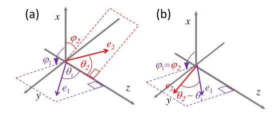
Рис. 3.12: Геометрия двухэлектронной эмиссии. Ось z обычно направлена либо вдоль вектора поляризации (для линейно поляризованного излучения), либо вдоль направления распространения полей (для поля круговой поляризации). (а) общий случай; (b) частный случай, когда направления вылета электронов и ось z компланарны.
