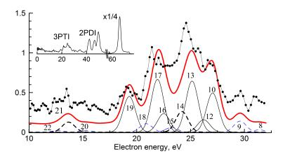
Рис. 3.22: Спектр фотоэлектронов при ионизации неона фотонами с энергией 90.5 эВ. Область преимущественно трехкратной ионизации.
