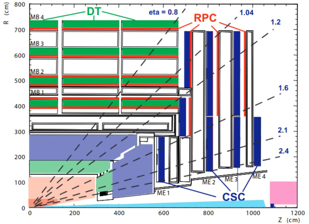
Рис. 2.7: Схема мюонной системы CMS
