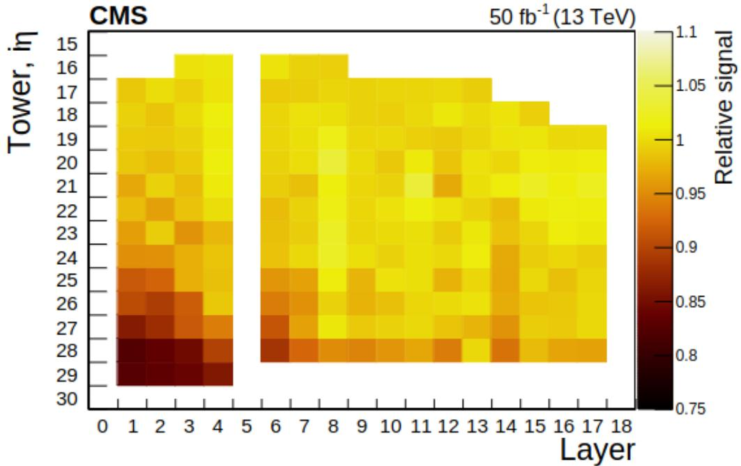
Рис. 3.7: Соотношение сигналов от источников  $^{60}Co$  2018 и 2017 года, как функция номера калориметрической башни  $i\eta$  и номера слоя калориметра в НЕ. Трубки для слоёв 0 и 5 не были доступны.
