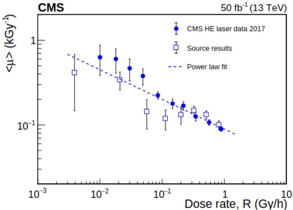
Рис. 3.8: Значение  $\langle \mu \rangle$  для сцинтиллятора  $SCSN - 81$  как функция  $R$  для данных лазера и источника  $^{60}Co$ , параметризованное степенным законом, который показан пунктирной линией.
