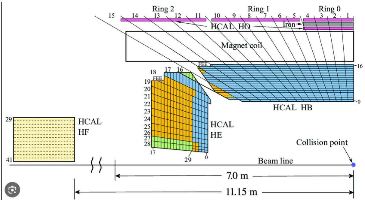
Рис. 2.6: Схема адронного калориметра CMS
