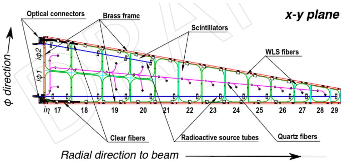
Рис. 3.4: Схема расположения пластиковых трубок (синим цветом), используемых для доставки радиоактивного источника
