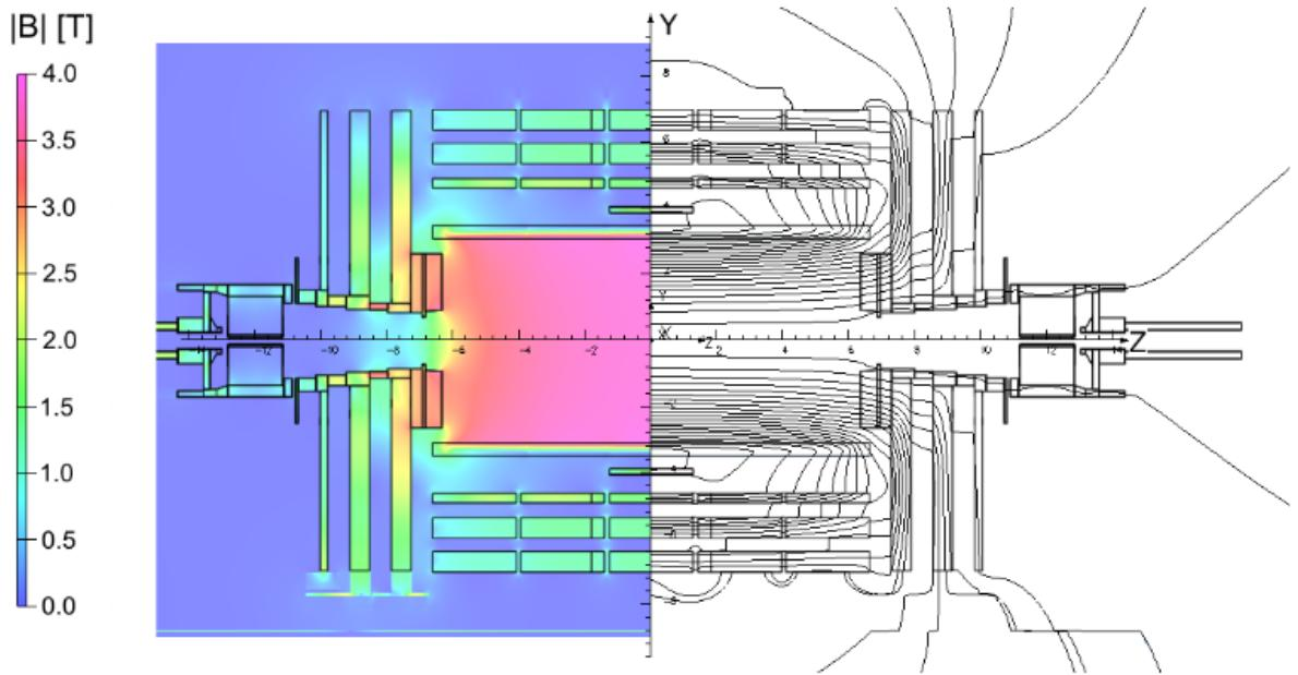
Рис. 2.3: Схема магнитного поля CMS. Величина магнитного поля в Тесла (слева), силовые линии магнитного поля (справа)
