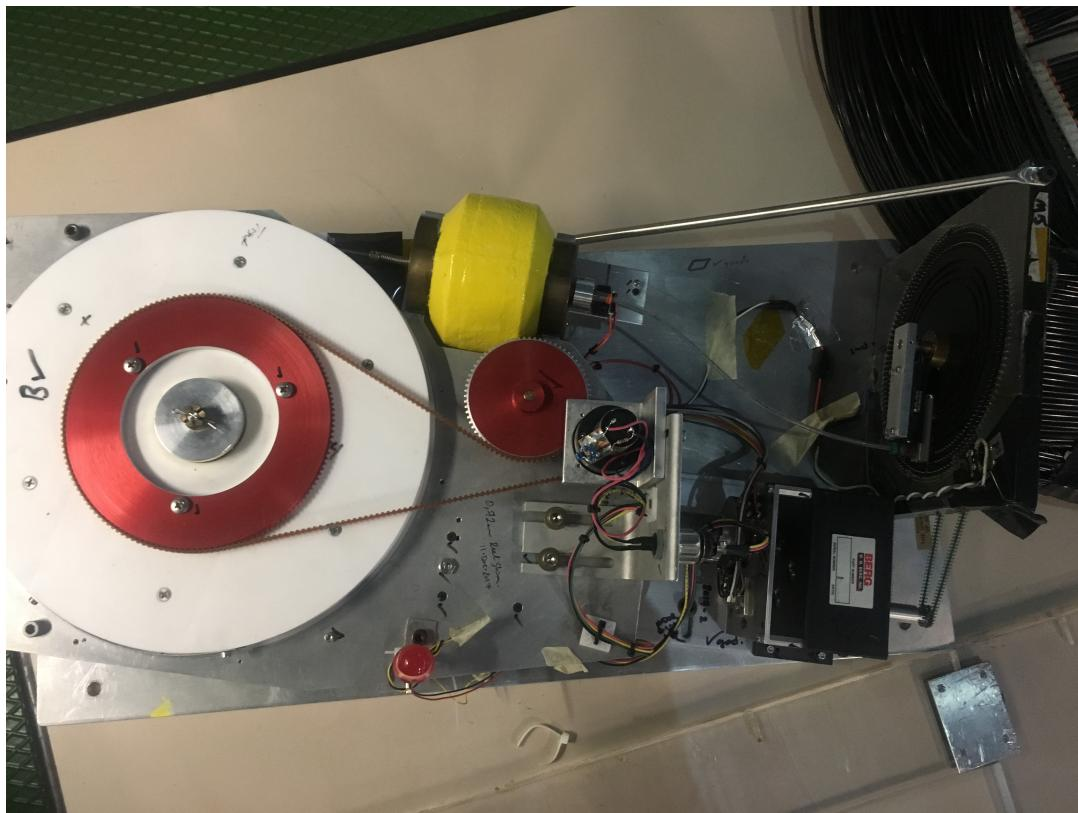
Рис. 3.3: Система доставки радиоактивного источника
