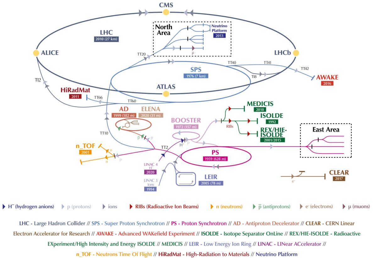
Рис. 2.1: Ускорительный комплекс Большой адронный коллайдер
