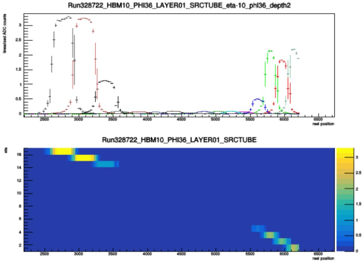
Рис. 3.6: Пример плохой последовательности сигналов при наборе данных с радиоактивным источником в детекторе НВ
