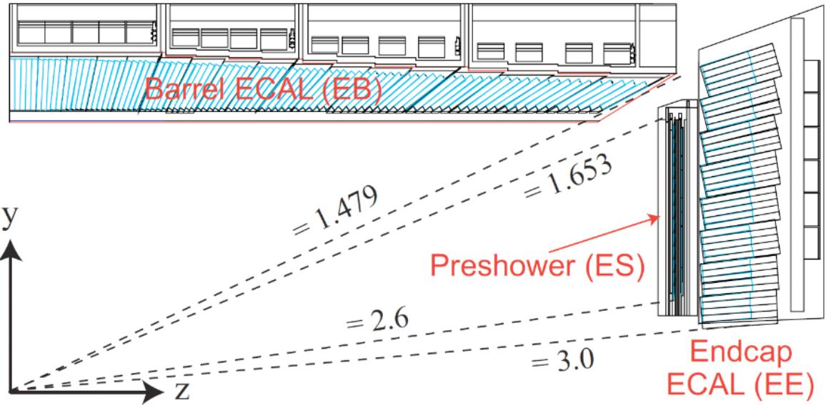
Рис. 2.5: Схема электромагнитного калориметра CMS. Пунктирными линиями показаны диапазоны по псевдобыстроте  $\eta$
