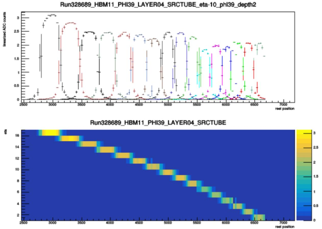
Рис. 3.5: Пример нормальной последовательности сигналов при наборе данных с радиоактивным источником в детекторе НВ
