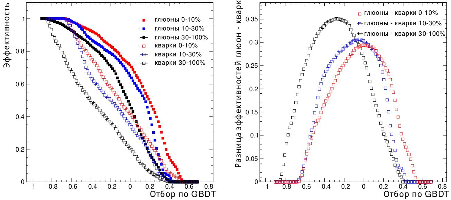
Рис. 6.6: Зависимость эффективности идентификации глюонных и кварковых струй (левый рисунок) и их разности (правый) в зависимости от порога по выходному значению GBDT для трех интервалов по центральности. Тренировка модели проведена на данных без эффекта гашения струй
