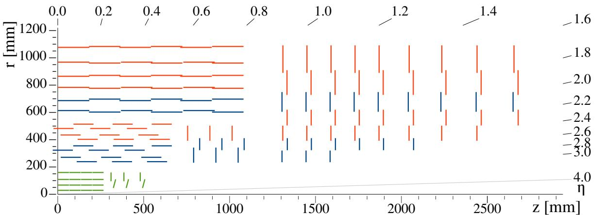
Рис. 2.4: Схема одной четвертой части трекового детектора CMS. Зеленым цветом показан пикельный детектор. Синим и красным - стриповый детектор
