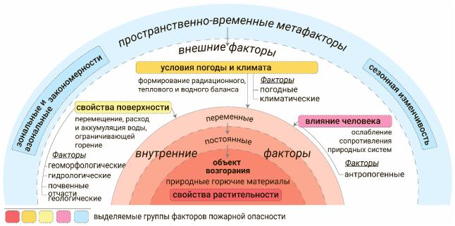
Рисунок 2. Предложенная классификация факторов пожарной опасности
