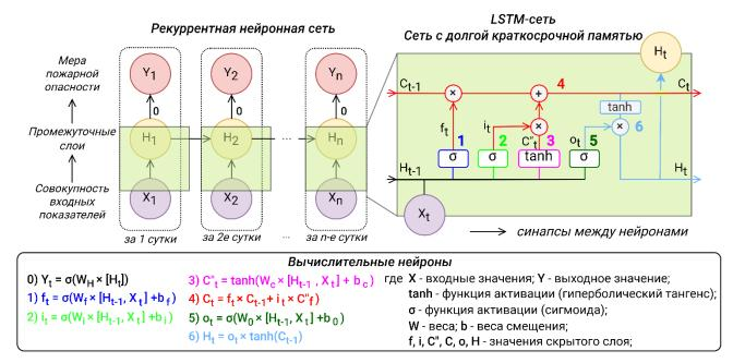
Рисунок 3. Архитектура используемой нейронной сети – рекуррентная LSTM сеть
