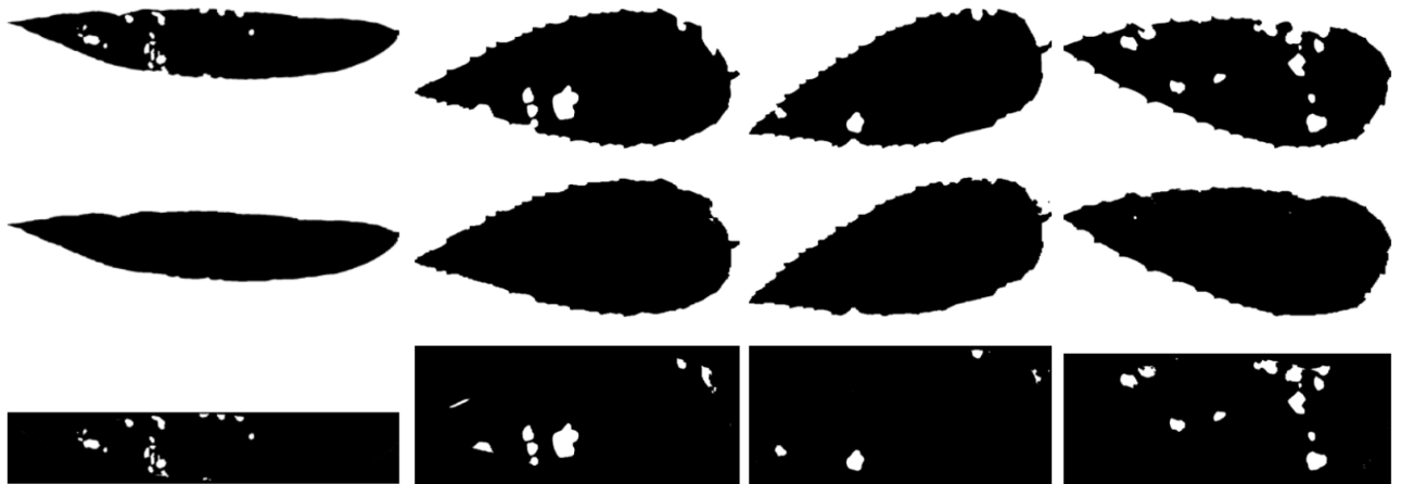
Рисунок 8. Результаты модели на основе архитектуры UNet++ на данных с естественными повреждениями. Верхний ряд – входные изображения поврежденных листьев в бинаризованной форме, предоставленные модели. Средний ряд – результаты масок, предсказанные моделью. Нижний ряд – поврежденная площадь: разница между средним и верхним рядом.
