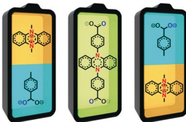
Рисунок 1. Схематическое изображение симметричной органической батареи, в которой электродным материалом является диарилдигидрофеназин. Рисунок взят из статьи [59].
