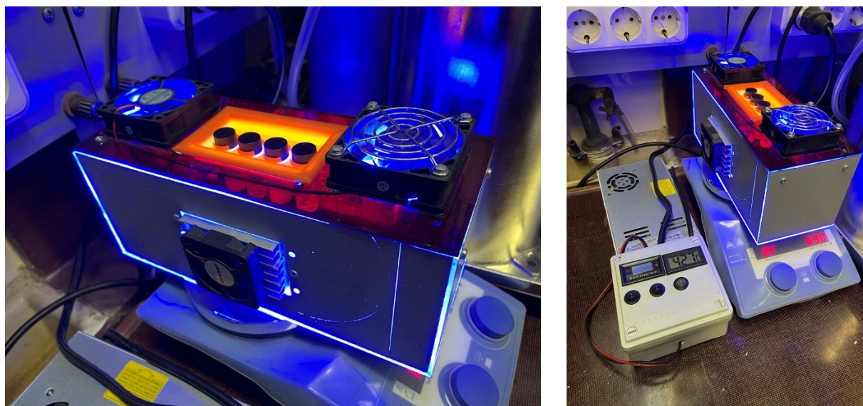
Рисунок 37. Фотореактор в работе (слева). Полная экспериментальная установка, состоящая из источника постоянного тока, управляющего блока, фотореактора и магнитной мешалки (справа).
