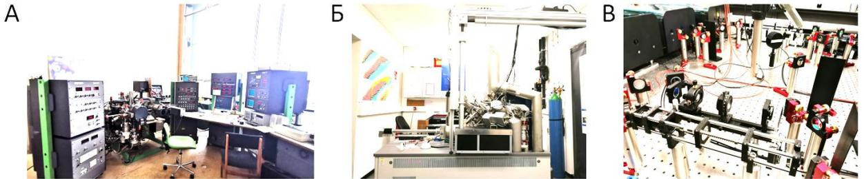
*Рис. 45. Масс-спектрометры вторичных ионов: масс-спектрометр CAMECA 4f (А), времяпролетный масс-спектрометр TOF-SIMS.5, IONTOF (Б), лазерная установка для регистрации резонансно-индуцированных масс-спектров (В).*
