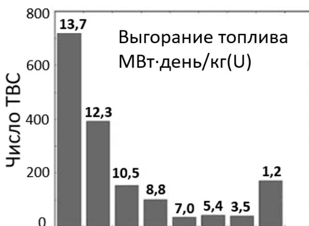
Рис. 1. Распределение ТВС по значениям выгорания топлива в четвертом энергетическом блоке ЧАЭС на момент аварии [52].
