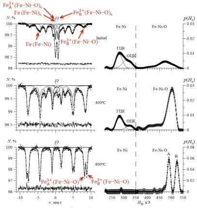
Рис. 14. Мессбауэровские спектры (слева) и результаты восстановления распределений сверхтонкого магнитного поля  $p(H_{\rm n})$  (справа) для наночастиц Fe-Ni / Fe-Ni-O, полученных при температурах отжига 25°C, 400°C и 800°C.
