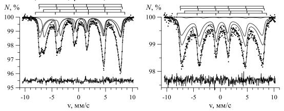
Рис. 7. Результаты модельной расшифровки мессбауэровских спектров исходных не покрытых ( $Fe_3O_4$ ) и покрытых золотом ( $Fe_3O_4$ @Au) наночастиц оксидов железа.
