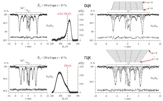
Рис. 5. Результаты восстановления распределения  $p(H_n)$  сверхтонкого магнитного поля  $H_n$  (слева) и модельной расшифровки (справа) мессбауэровских спектров нанотрубок  $Fe_{70}Ni_{30}$  и  $Fe_{10}Ni_{90}$ .
