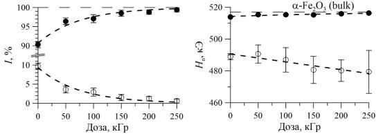
Рис. 13. Дозовые зависимости относительных интенсивностей I (слева), сверхтонких магнитных полей  $H_{\rm n}$  (справа) для парциальных мессбауэровских спектров ядер  $^{57}$ Fe в локально однородных ( $\bullet$ ) и локально неоднородных ( $\circ$ ) областях наночастиц оксида  $\alpha$ -Fe<sub>2</sub>O<sub>3</sub>.
