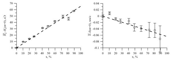
Рис. 4. Концентрационные зависимости вклада в сверхтонкое магнитное поле (слева) и в сдвиг мессбауэровского спектра (справа), вызванного замещением атомов Fe на атомы Co при неизменных расстояниях между атомами в  $Fe_{100-x}Co_x$  нанотрубках.
