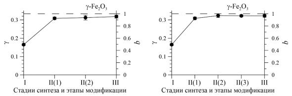
Рис. 11. Изменения числа кислородных вакансий на формульную единицу магнетита  $\gamma$  и молярной концентрации маггемита b в процессе модификации поверхности методами A (слева) и Б (справа) и синтеза наночастиц оксида железа  $Fe_3O_4$  с покрытием карбораном. Штриховые линии соответсвуют значениям для чистого маггемита  $\gamma$ - $Fe_2O_3$ .
