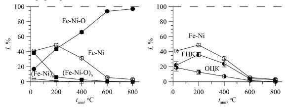
Рис. 15. Зависимости относительных интенсивностей парциальных спектров оксида Fe-Ni-O ( $\bullet$ ), Fe-Ni сплавов ( $\circ$ ), оксидных (Fe-Ni-O)<sub>n</sub> ( $\blacksquare$ ) и металлических (Fe-Ni)<sub>n</sub> ( $\square$ ) суперпарамагнитных наночастиц (слева), а также Fe-Ni сплавов с ОЦК и ГЦК решетками от температуры отжига (справа).
