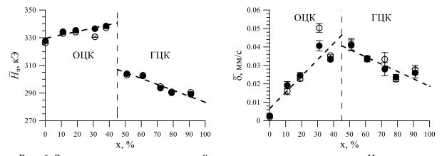
Рис. 6. Зависимости средних значений сверхтонкого магнитного поля  $H_n$  и сдвига  $\delta$  от концентрации Ni, полученная в результате восстановления распределений сверхтонкого магнитного поля ( $\circ$ ) и модельной расшифровки ( $\bullet$ ).
