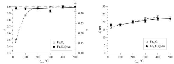
Рис. 9. Зависимости от температуры отжига  $t_{\rm ann}$  молярной концентрации маггемита b и степени нестехиометрии  $\gamma$  (слева), а также среднего размера области магнитного упорядочения d (справа) для нестехиометрического магнетита в Fe<sub>3</sub>O<sub>4</sub> и Fe<sub>3</sub>O<sub>4</sub>@ Au наночастицах.
