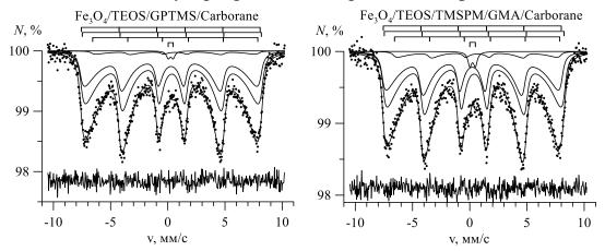
Рис. 10. Результаты модельной расшифровки мессбауэровских спектров покрытых карбораном наночастиц оксида железа  $Fe_3O_4$  после модификации поверхности методом A (слева) и B (справа).
