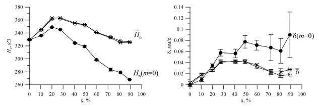
Рис. 2. Концентрационные зависимости средних значений сверхтонкого магнитного поля  $\overline{H}_n$  и сдвига спектра  $\overline{\delta}$ , полученные в результате модельной расшифровки ( $\circ$ ) и восстановления распределения сверхтонких параметров ( $\times$ ), а также концентрационные зависимости поля  $H_n(m=0)$  и сдвига  $\delta(m=0)$  для атомов Fe, в ближайшем окружении которых нет атомов Co ( $\bullet$ ).
