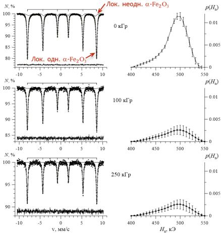
Рис. 12. Результаты обработки мессбауэровских спектров ядер  $^{57}$ Fe в наночастицах оксида  $\alpha$ -Fe<sub>2</sub>O<sub>3</sub>, облученных потоком электронов с дозой 0, 100 и 250 кГр.
