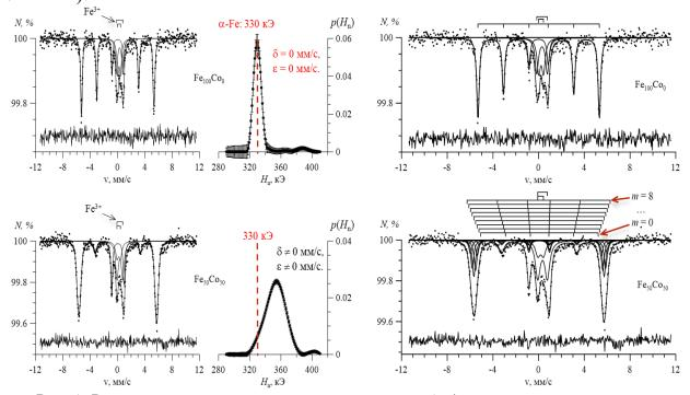
Рис. 1. Результаты восстановления распределения  $p(H_n)$  сверхтонкого магнитного поля  $H_n$  (слева) и модельной расшифровки (справа) мессбауэровских спектров нанотрубок  $Fe_{100}Co_0$  и  $Fe_{50}Co_{50}$ .
