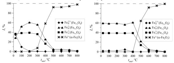
Рис. 8. Относительные интенсивности парциальных спектров, соответствующих различным состояниям атомов Fe в Fe<sub>3</sub>O<sub>4</sub> (слева) и Fe<sub>3</sub>O<sub>4</sub>@Au (справа) наночастицах, в зависимости от температуры отжига  $t_{\rm ann}$ .
