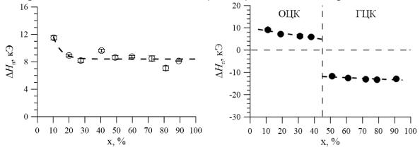
Рис. 3. Концентрационные зависимости изменения сверхтонкого магнитного поля  $\Delta H_{\rm n}$ , вызванного замещением атома Fe на атом Co (слева) или Ni (справа) в ближайшем окружении атома железа в Fe<sub>100-x</sub>Co<sub>x</sub> и Fe<sub>100-x</sub>Ni<sub>x</sub> нанотрубках соответственно.
