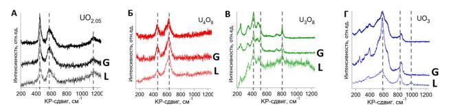
Рис. 3. Спектры комбинационного рассеяния оксидов урана до и после выдерживания в имитаторах легочной жидкости (L) и жидкостях ЖКТ (G): (A) UO<sub>2,05</sub>; (Б) U<sub>4</sub>O<sub>9</sub>; (В) U<sub>3</sub>O<sub>8</sub>; (Г) UO<sub>3</sub>. «G» в названии образца означает, что этот образец был выдержан в имитаторах жидкостей желудочно-кишечного тракта, «L» в названии образца означает, что образец выдерживали в имитаторе легочной жидкости.
