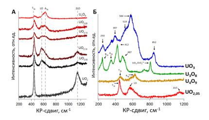
Рис. 1. Спектры KP (A) серии оксидов урана от  $UO_2$  до  $U_4O_9$ ; (Б) оксидов, использованных в эксперименте по растворению в биологических жидкостях  $UO_{2,05}$ ,  $U_4O_9$ ,  $U_3O_8$  и  $UO_3$ .
