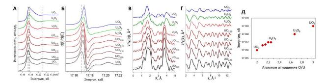
Рис. 2. XANES спектры на  $L_3$  крае урана для разновалентных оксидов урана (A) и их первые производные (Б); EXAFS спектры на  $L_3$  крае урана для референсных оксидов в различных степенях окисления (В) и их Фурье-трансформанты (Г). Непрерывные линии соответствуют экспериментальным данным, пунктирные линии соответствуют расчетным данным. Энергетическое положение первой производной спектра XANES в зависимости от атомного соотношения кислорода к урану в оксидах (Д).
