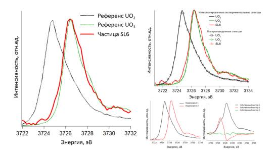
Рис. 10. Анализ линейной комбинации спектров рентгеновского погложения референсных оксидов урана в спектре частиц SL6 на M<sub>4</sub> крае урана.
