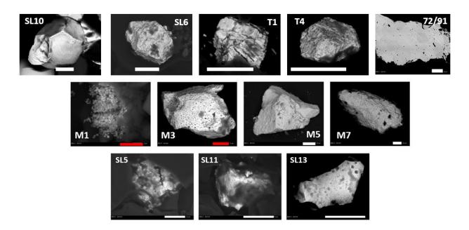
Рис. 7. РЭМ-изображения в режиме ОРЭ «горячих» частиц Западного следа: **SL10**, **SL6**, **SL5**, **SL11**, **SL13**, **T1**, **T4**, **72/91**, **T5**, **T2**, **T7**, **SL12**; Северного следа: **M1**, **M3**, **M5**, **M7**. Масштабные линейки: красная – 5 мкм, белая – 20 мкм.
