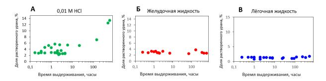
Рис. 4. Кинетические кривые растворения оксида урана  $UO_{2,05}$  в различных растворах: простейшем имитаторе желудочной жидкости 0,01M HCl (A), имитаторе желудочной жидкости (B).
