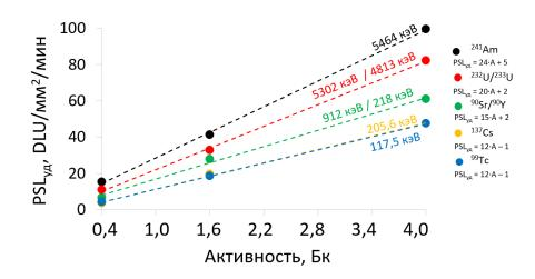
Рис. 5. Градуировка отклика Imaging Plate по эффективности. Зависимость прироста удельной PSL в единицу времени от активности образца.
