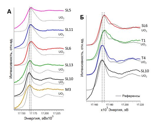
Рис. 8. XANES спектры «чернобыльских «горячих» частиц **SL5**, **SL11**, **SL6**, **SL13**, **SL10** и **M3** вместе со спектрами референсных образцов оксидов урана  $UO_2$  и  $UO_3$  (A). HERFD XANES спектры на  $L_3$ -крае урана «горячих» частиц **SL6**, **T1** и **T4** и XANES спектр на  $L_3$ -крае урана «горячей» частицы **SL10** вместе со спектрами референсных образцов оксидов урана  $UO_2$  и  $UO_3$  (Б).
