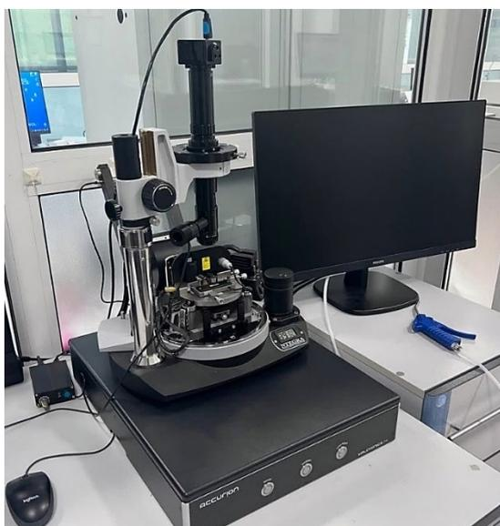
Рисунок 19. Сканирующий зондовый микроскоп NTEGRA (EMTION, Россия).
