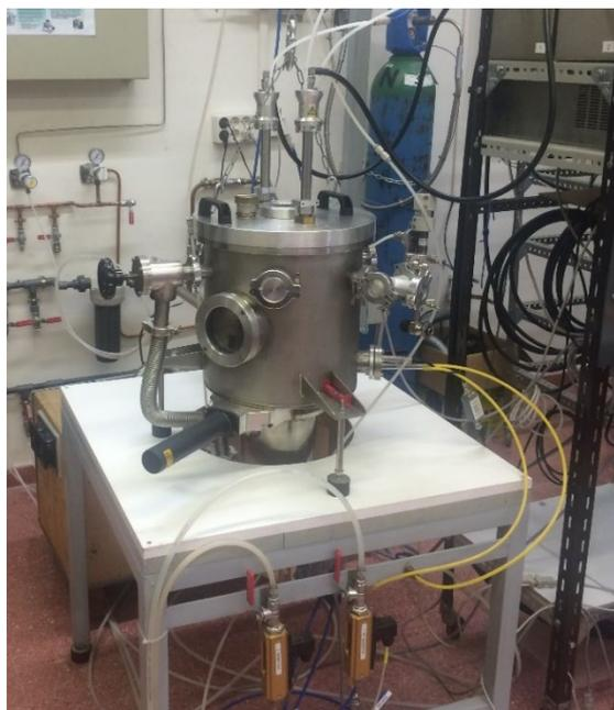
Рисунок 17. Фотография установки магнетронного напыления в Институте Материаловедения Мадрида [156].
