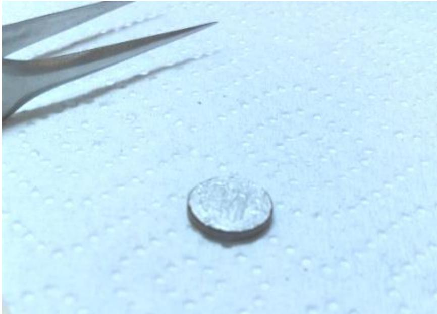
Рис. 44. Характерный вид конденсатора для измерения температурных зависимостей диэлектрической проницаемости.
