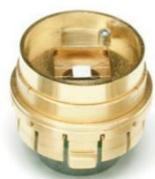
Рис. 42. Фотография держателя калориметра без крышки. [53]
