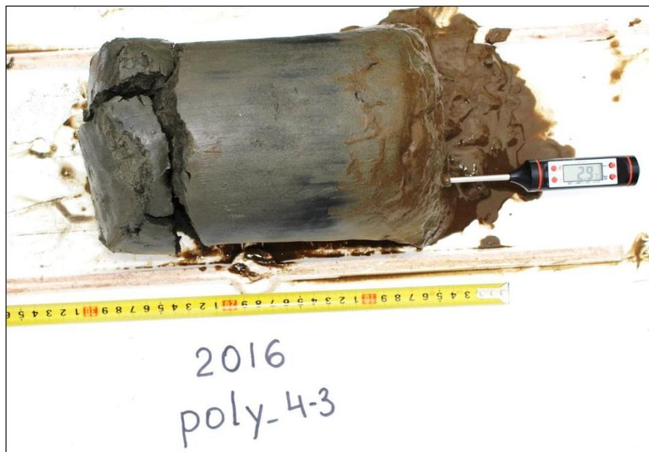
Рисунок 24. Измерение температуры и фотодокументация керна
