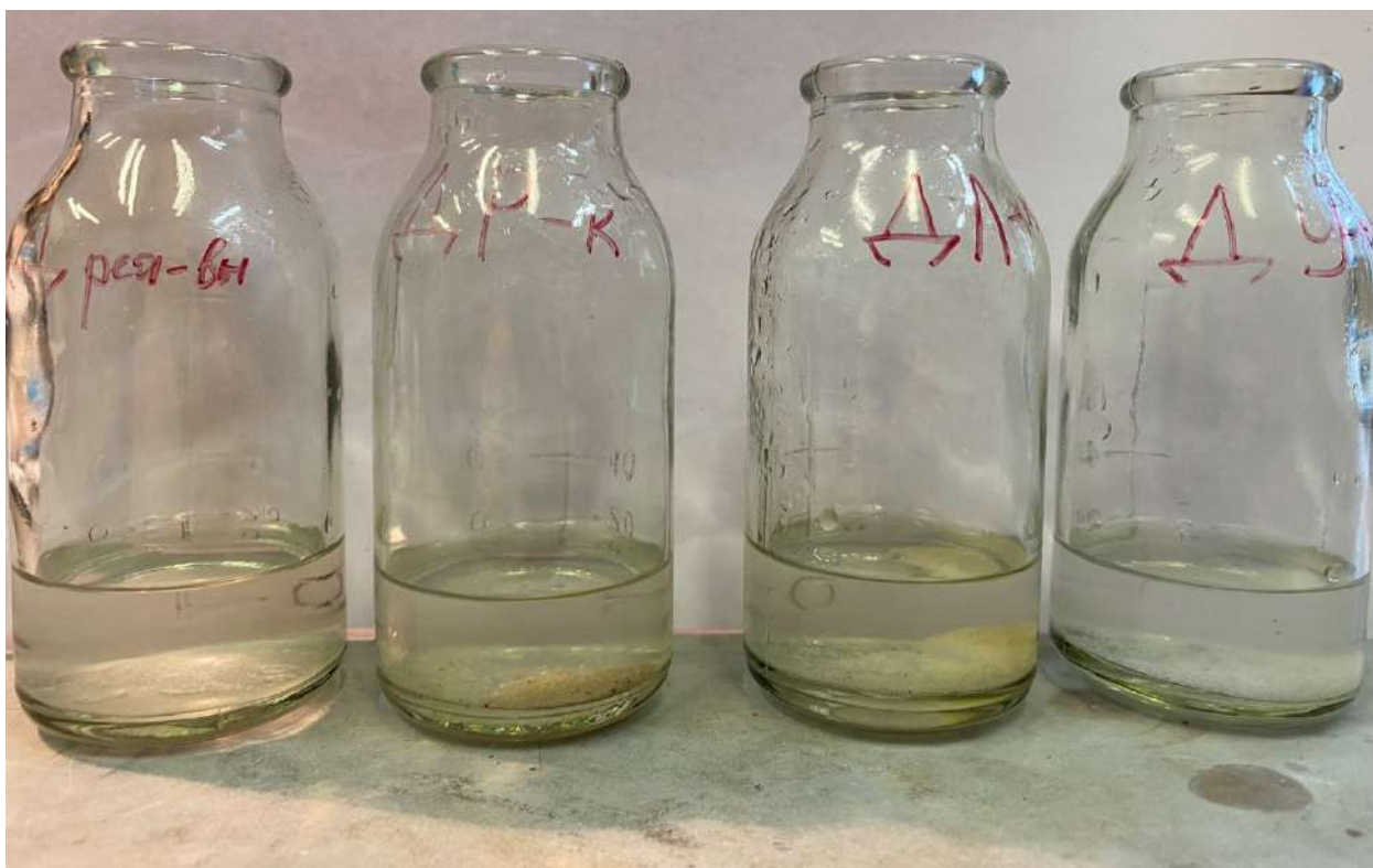
Рисунок 37. Сосуды с исследуемыми растворами водных вытяжек из песчаных грунтов при определении ферментативной активности дегидрогеназы
