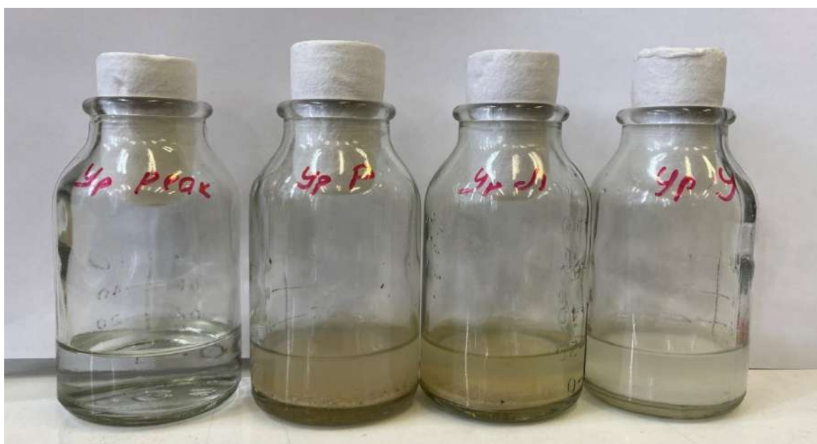
Рисунок 39. Сосуды с исследуемыми растворами водных вытяжек из песчаных грунтов при определении ферментативной активности уреазы
