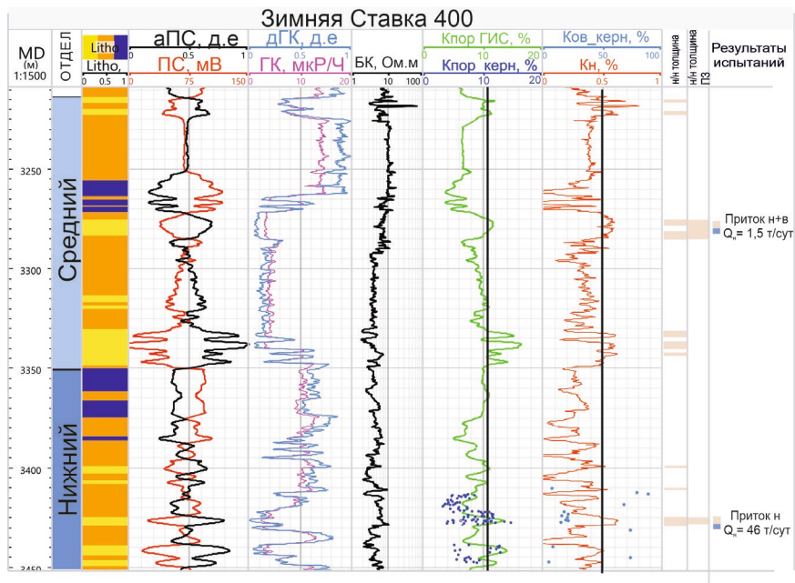
Рисунок 9 Анализ интерпретации данных ГИС ниже-среднеюрских пород по скв. Зимняя Ставка 400 и сравнение нефтенасыщенных толщин, принятых по подсчёту запасов 2015 года, и рассчитанных автором с применением петрофизической типизации пород.
