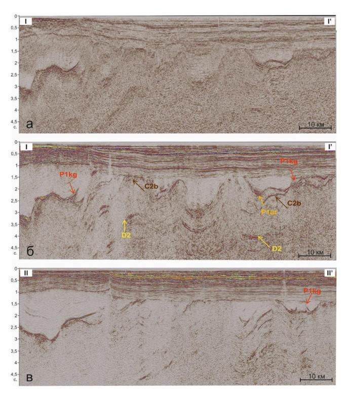
Рис. 2.1. 4 Сравнение обработки. Временные сейсмические разрезы по линиям: а - I-I' (обработка начала 2000 гг.), б — I-I' и в — II-II' (обработка 2018 г. по современному графу)
