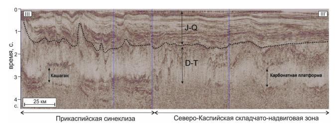
Рис. 5. 9 Временной сейсмический разрез, иллюстрирующий карбонатную платформу
