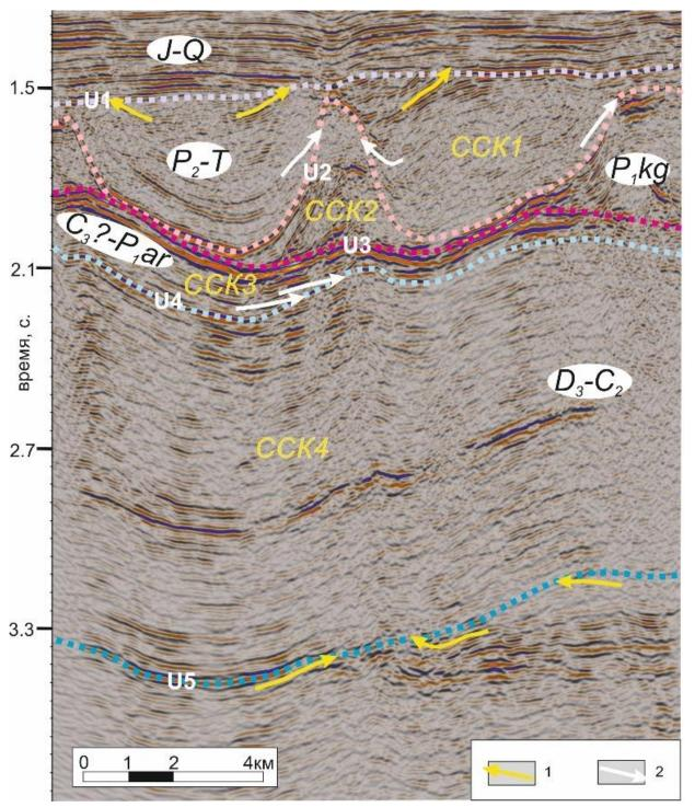
Рис. 2.3. З Характер выраженности поверхностей несогласий и реперных горизонтов на временном разрезе через южную часть Северного Каспия
