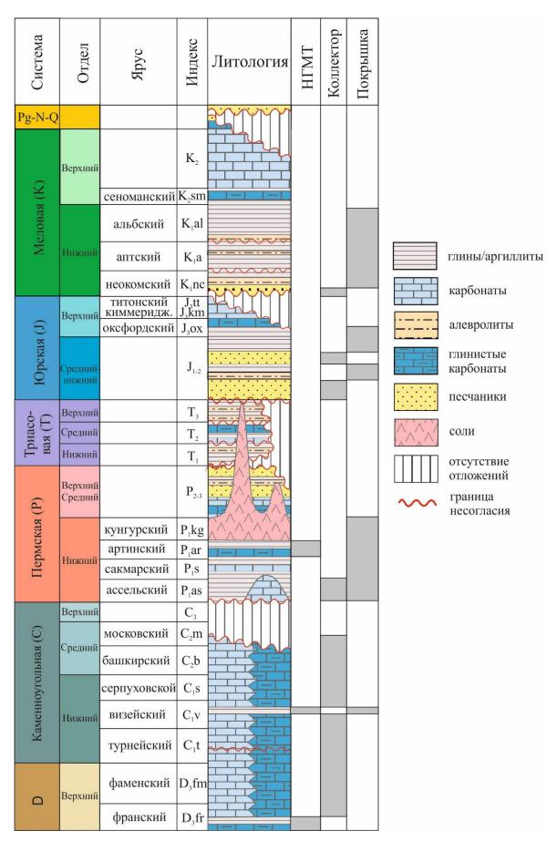
Рис. 5. 1 Стратиграфическая колонка Северного Каспия с элементами нефтяной системы
