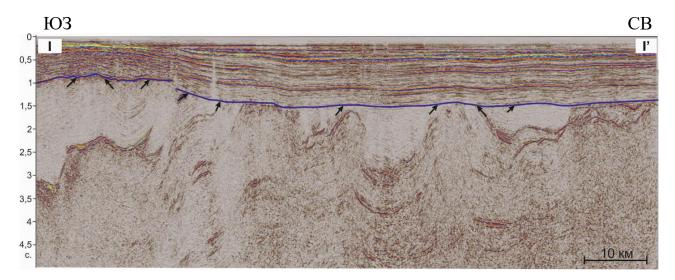
Рис. 2.3. 4 Пример выделения предъюрского несогласия U1 на временном разрезе через южную часть Северного Каспия
