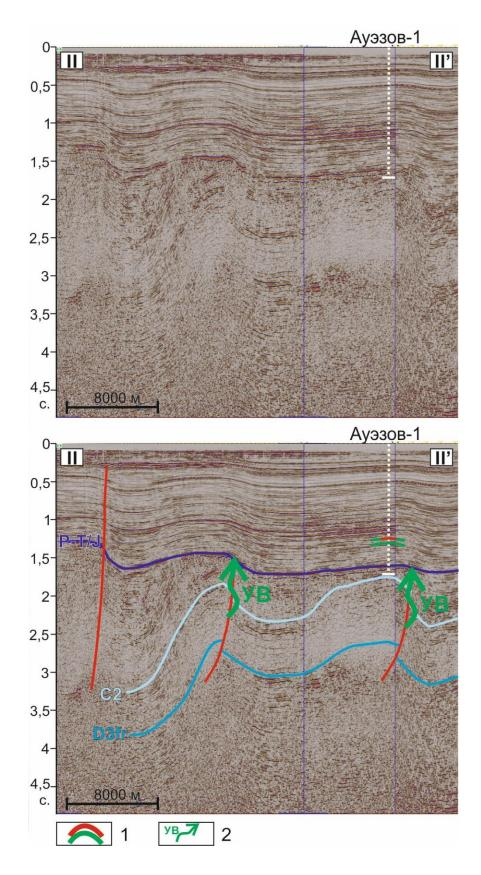
Рис. 5. 3 Сейсмогеологический профиль через структуру Хазар и Каламкасморе
