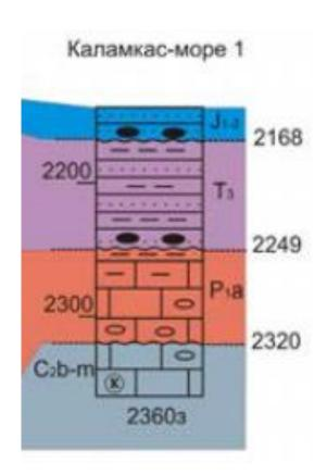
Рис. 2.3. 8 Разрез скважины Каламкас-море-1 [Пронин, Шестоперова, 2019]
