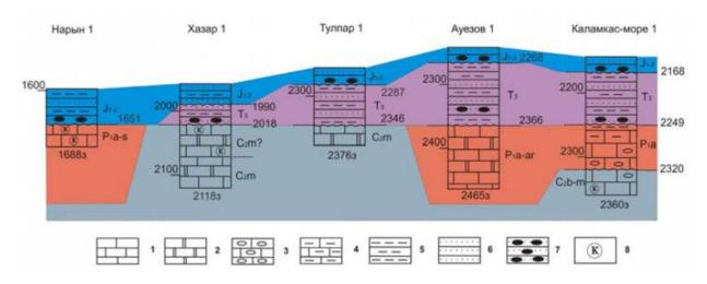
Рис. 5. 5 Схема корреляции верхнепалеозойских и верхнетриасовых отложений [Пронин, Шестоперова, 2019]
