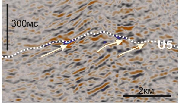
Рис. 2.3. 10 Девонское несогласие U5 на временных разрезах
