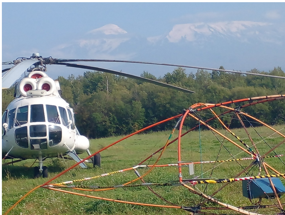
Рисунок 3. Вертолет Ми-8Т оборудованный комплексом ЭКВАТОР (п. Майский, п-ов Камчатка, 2021 г.)
