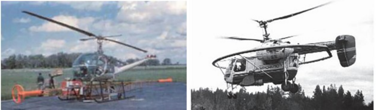
Рисунок 1.4. Частотная и временная вертолетные системы слева — частотная система с жестким креплением передатчика относительно приемника Texas Gulf Sulphur, 1964 г.; справа — система, реализующая метод переходных процессов АМПП-2, 1972 г.
