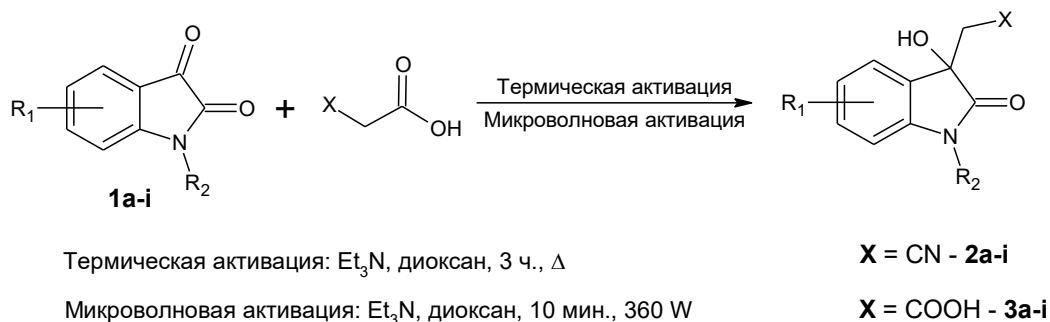
Рисунок 1. Синтез 3-гидрокси-2-оксиндолов 2a-i и 3a-i методами термической или микроволновой активации
