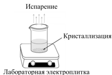
Рис. 58. Вариант комплекса экспериментальной аппаратуры для синтеза иодатов металлов методом испарения растворителя [169].
