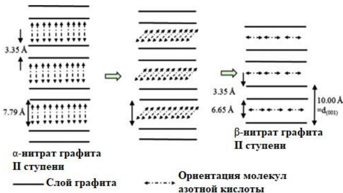
Рисунок 6 – Переориентация молекул азотной кислоты при промывке ацетонитрилом \alpha -нитрата графита и образование \beta -нитрата графита [80]
