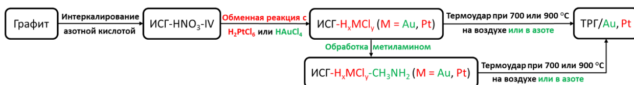
Рисунок 87 – Блок-схема получения композитов ТРГ/Au, ТРГ/Pt
