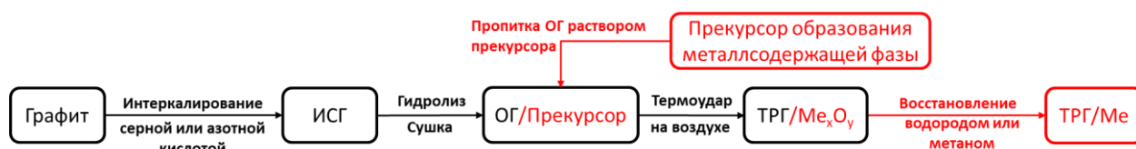
Рисунок 20 – Блок-схема получения металлсодержащего ТРГ путем введения прекурсора в окисленный графит с последующей термообработкой
