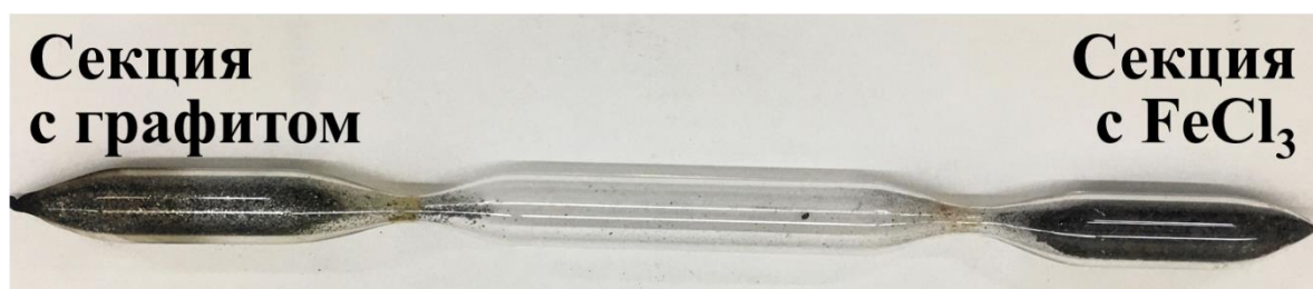
Рисунок 23 – Заполненная ампула для градиентного способа синтеза ИСГ-FeCl 3
