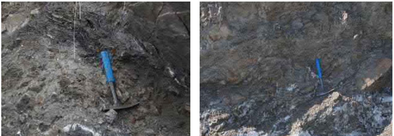
Рис. 3-13. Терригенные отложения (полностью дезинтегрированные первично флишевые образования) в языковой части каменной лавины. Фотографии О.В. Зеркаля и Е.Н. Самарина (МГУ).
