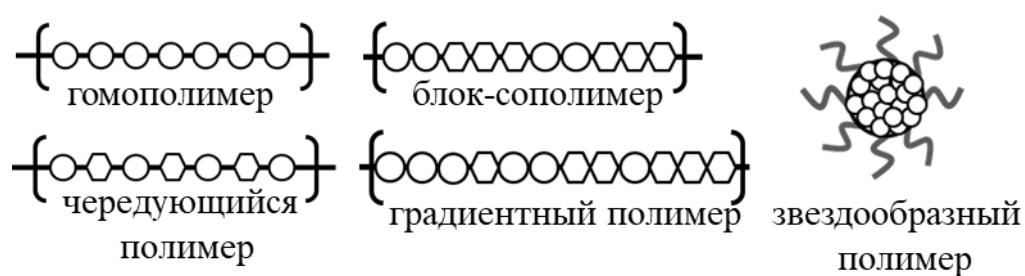
Рисунок 1. Примеры ПЭ с разной топологией [3, 5-7].
