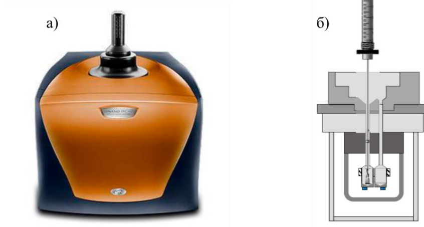
Рисунок 2.16. а) Изотермический калориметр Nano ITC. б) Схема измерительных ячеек.
