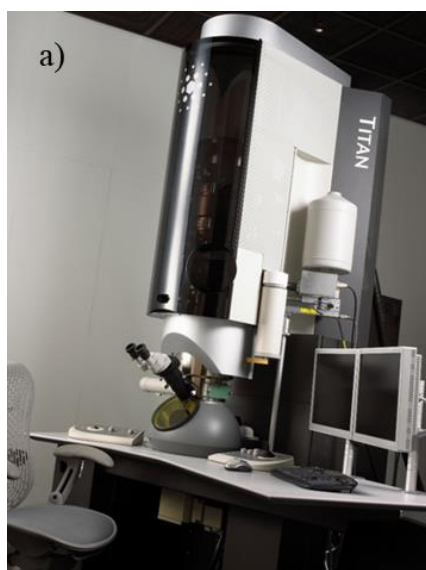
Рисунок 2.13. а) Электронный микроскоп Титан Криос 60-300. б) Схема устройства микроскопа.
