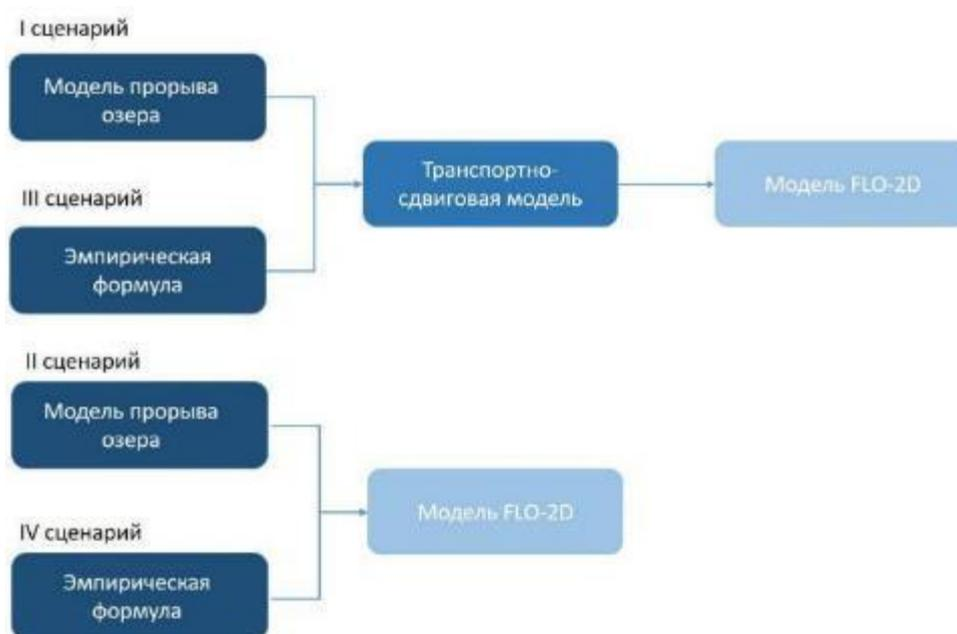
Рисунок 6.1. Схема используемого комплекса математических моделей для сценариев моделирования в долине реки Бодомдара.
