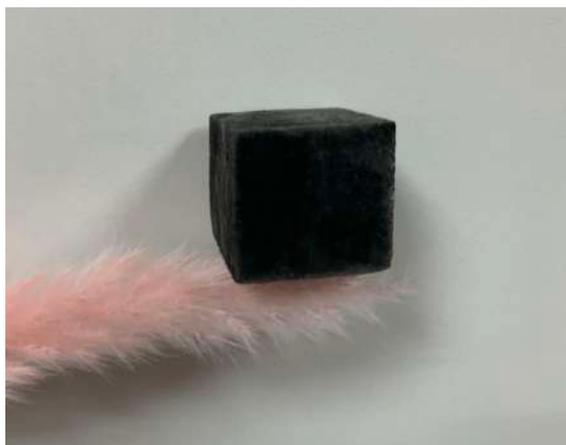
Рисунок 3.19. Образец композита М-ВОГ-ак, помещенного на перо
