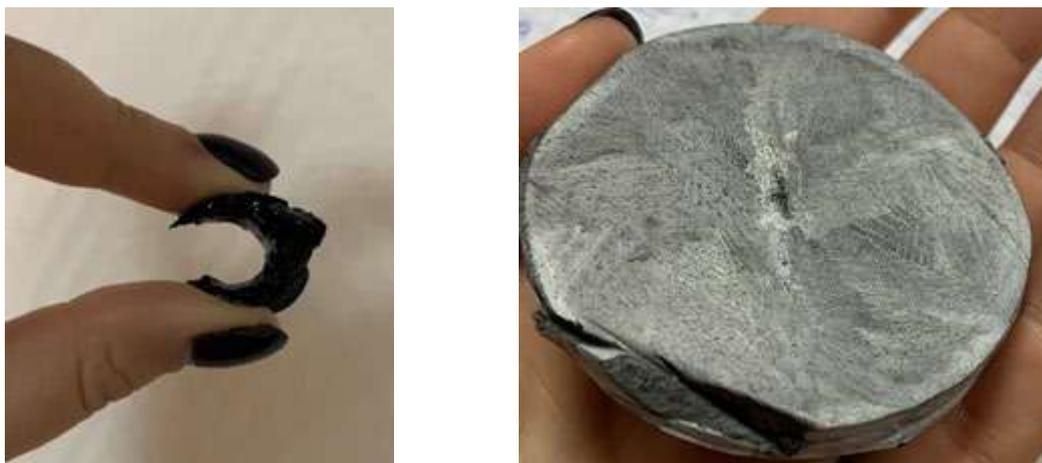
Рисунок 3.53. «Плотный» аэрогель, синтезированный по предложенной методике
