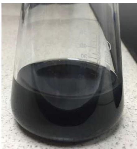
Рисунок 2.6. Коллоидный раствор углеродных нанотрубок после обработки в ультразвуковой ванне
