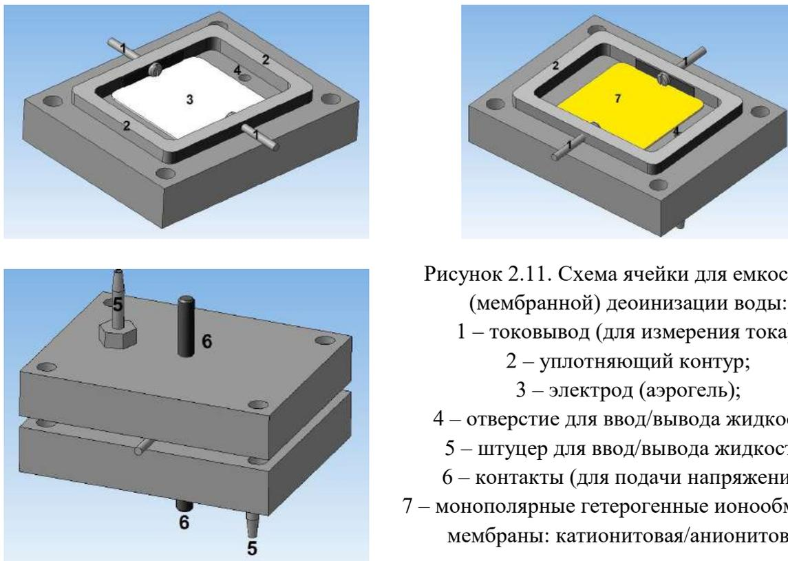
Рисунок 2.11. Схема ячейки для емкостной (мембранной) деионизации воды:
