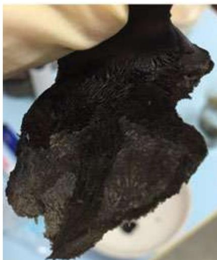
Рисунок 3.52. «Легкий» аэрогель, синтезированный по предложенной методике
