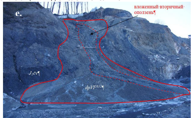
Участок "Русские горки" (Красная Поляна). д. Флишевые образования чжежипсинской свиты ( J_1čv ), размокающие при увлажнении. е. Оползень течения
