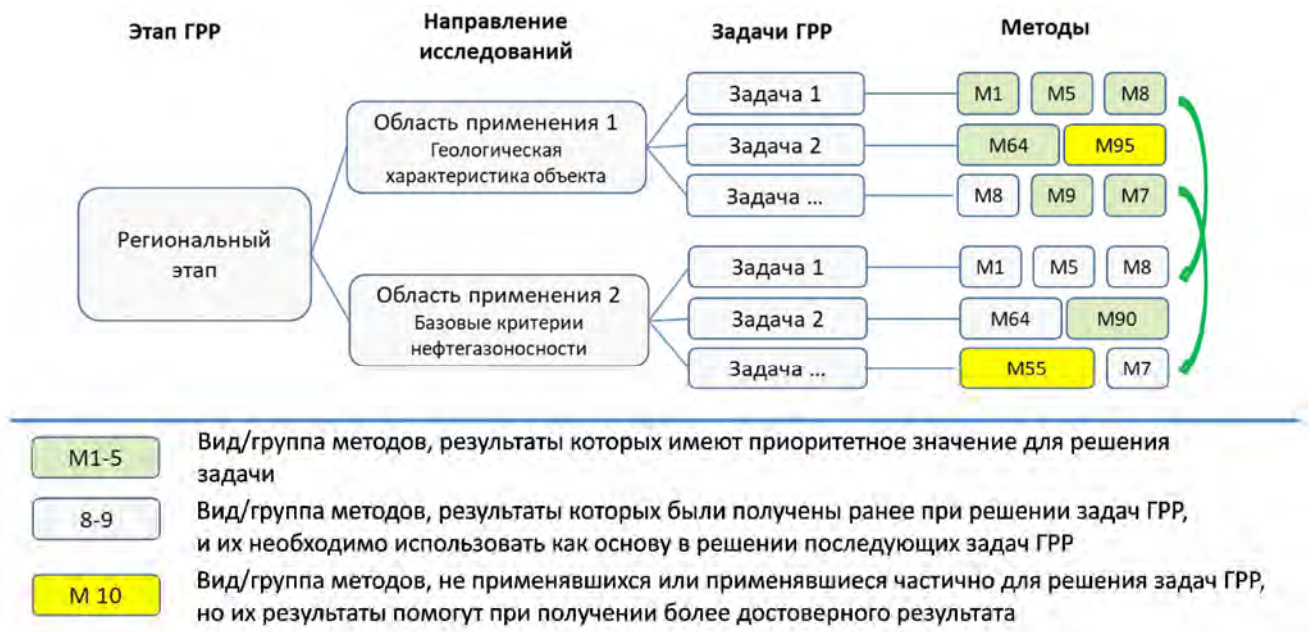
Рисунок 72 — Алгоритм выбора комплекса методов для решения задач геологоразведочных работ [Поляков, Ступакова, Малышев и др., 2025]
