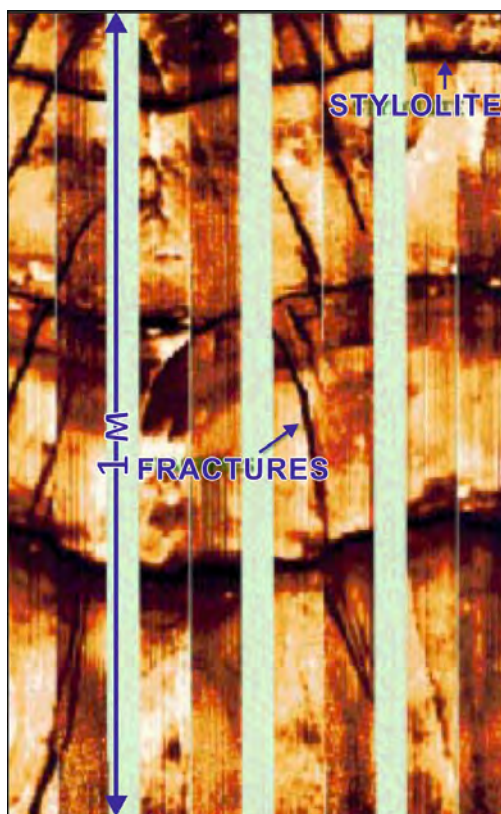
Рисунок 90 — Наклонные трещины и субгоризонтальные стилолитовые швы, выделенные методом микроэлектромагнитного сканирования [Akbar et al., 1995]. Права на иллюстрацию принадлежат журналу Oilfield Review. Используется с разрешения компании Schlumberger
