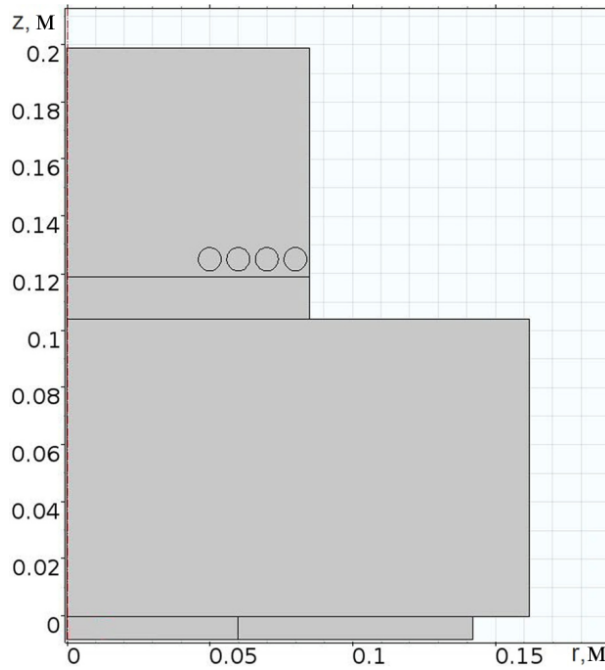
Рисунок 2.1 – Схема простой цилиндрической установки индукционного разряда
