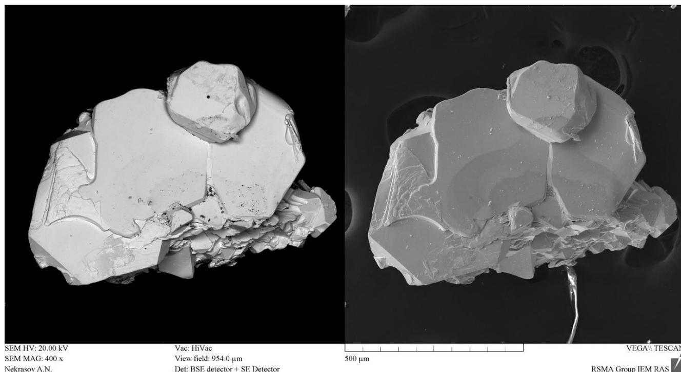
**Рисунок 51.** Электронное изображение кристаллов низкозамещенного  $ss\text{-PtTe}_2$  в режиме отраженных (слева) и вторичных электронов.
