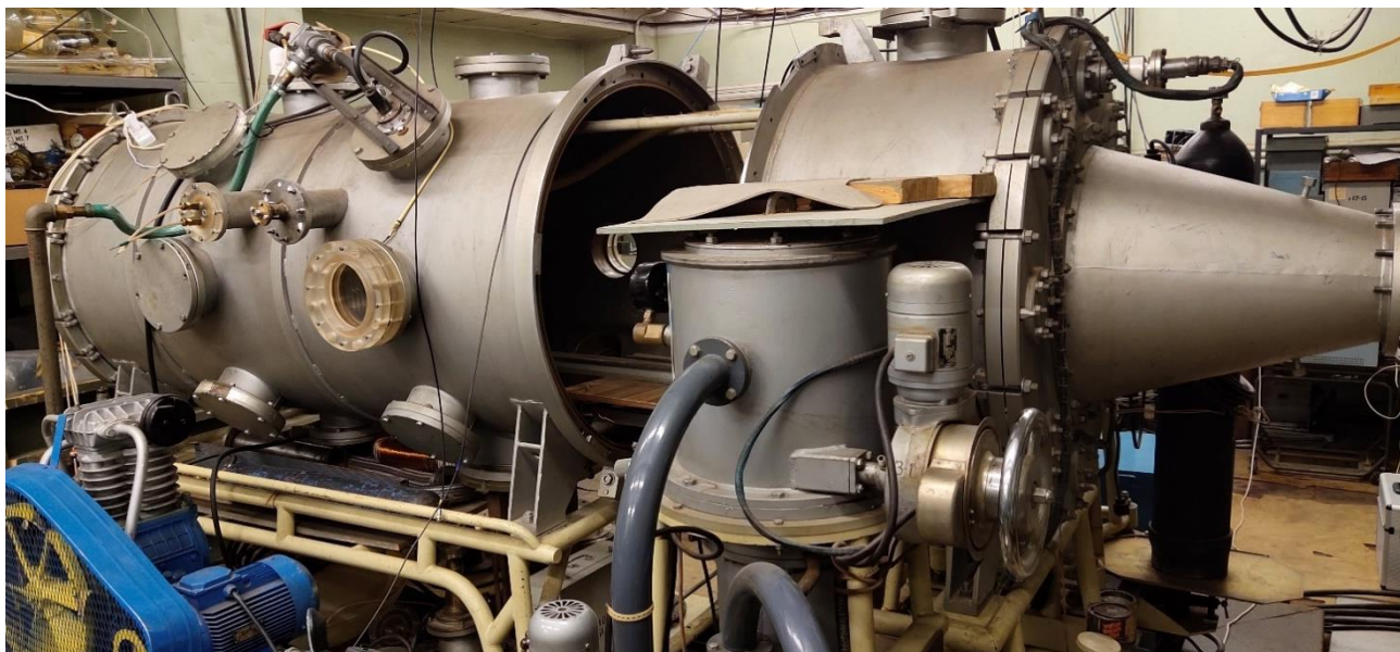
Рис. 2.1. Общий вид вакуумной камеры, используемой для создания различных электрических разрядов в сверхзвуковых газовых потоках.
