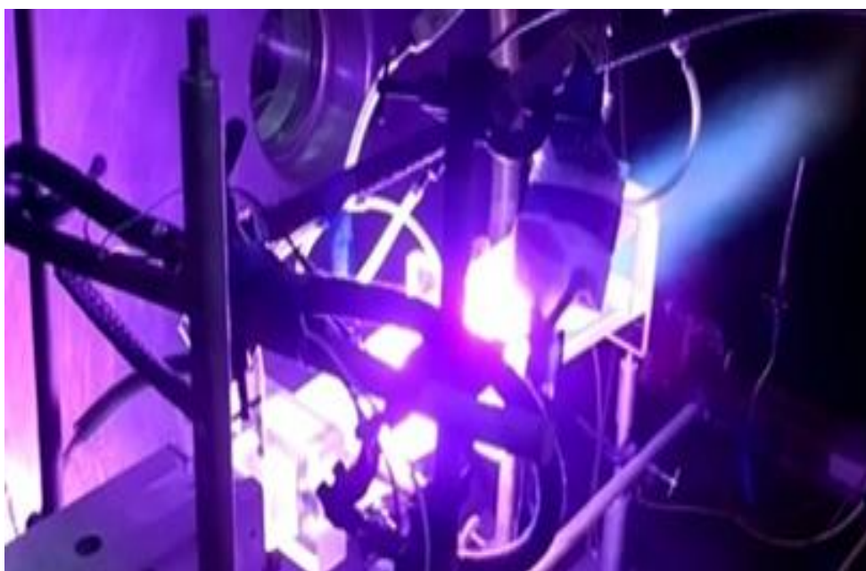
Рис. 5.21 Экспериментальная проверка поджига пропана. Фотография плазменно-стимулированного горения пропан-воздушного топлива в расширяющемся аэродинамическом канале длиной L=50 см. Время экспозиции кадра t_{\text{exp}} = 16 мс из полного времени пуска 2 с.
