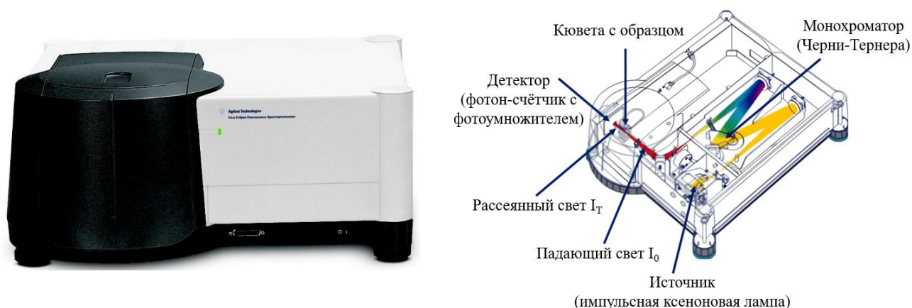
Рисунок 20 – Экспериментальная установка флуоресцентного спектрометра «Cary Eclipse» и ее оптическая схема [95]
