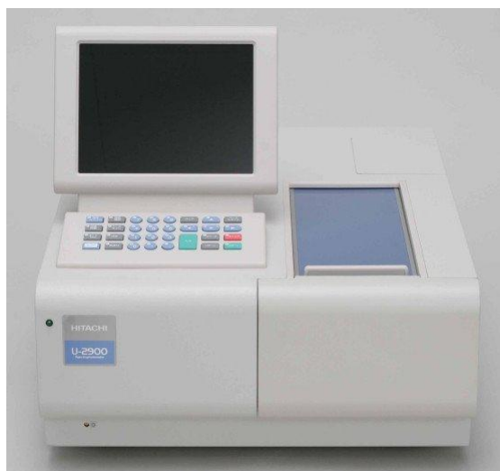
Рисунок 21 – Экспериментальная установка спектрофотометра «HITACHI U-2900» и ее оптическая схема [94]
