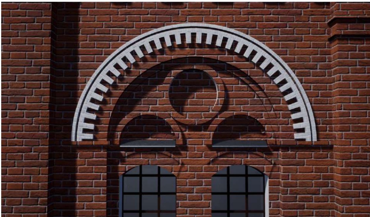
Рис. 11. Пример некорректного отображения кирпичной кладки на элементах декора, поскольку данные элементы не были проработаны при создании UV-развертки. Скриншот из движка Unreal Engine 4.
