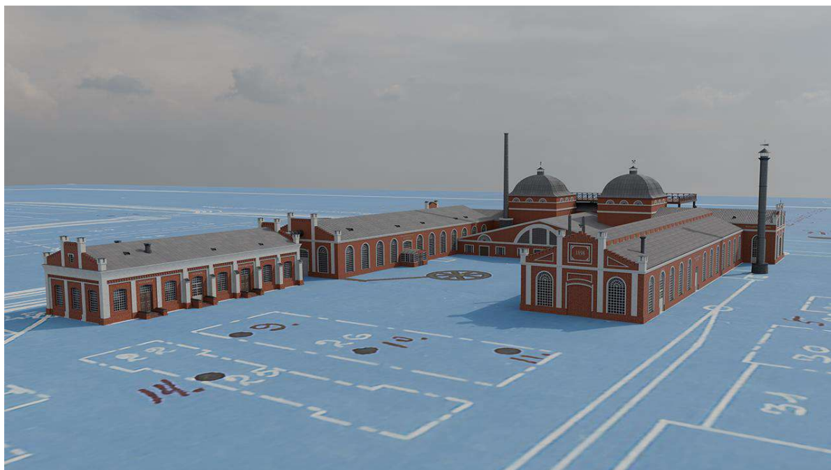
Рис. 54. Финальные рендеры строений Баранчинского завода. Реконструированы корпуса литейной и механической фабрик, доменных печей и доменного двора, ваграночного корпуса, корпуса паровой машины, здание турбины Жирарда, здание машины Каупера. Рендер из ПО Blender при использовании алгоритма рендеринга «Cycles».
