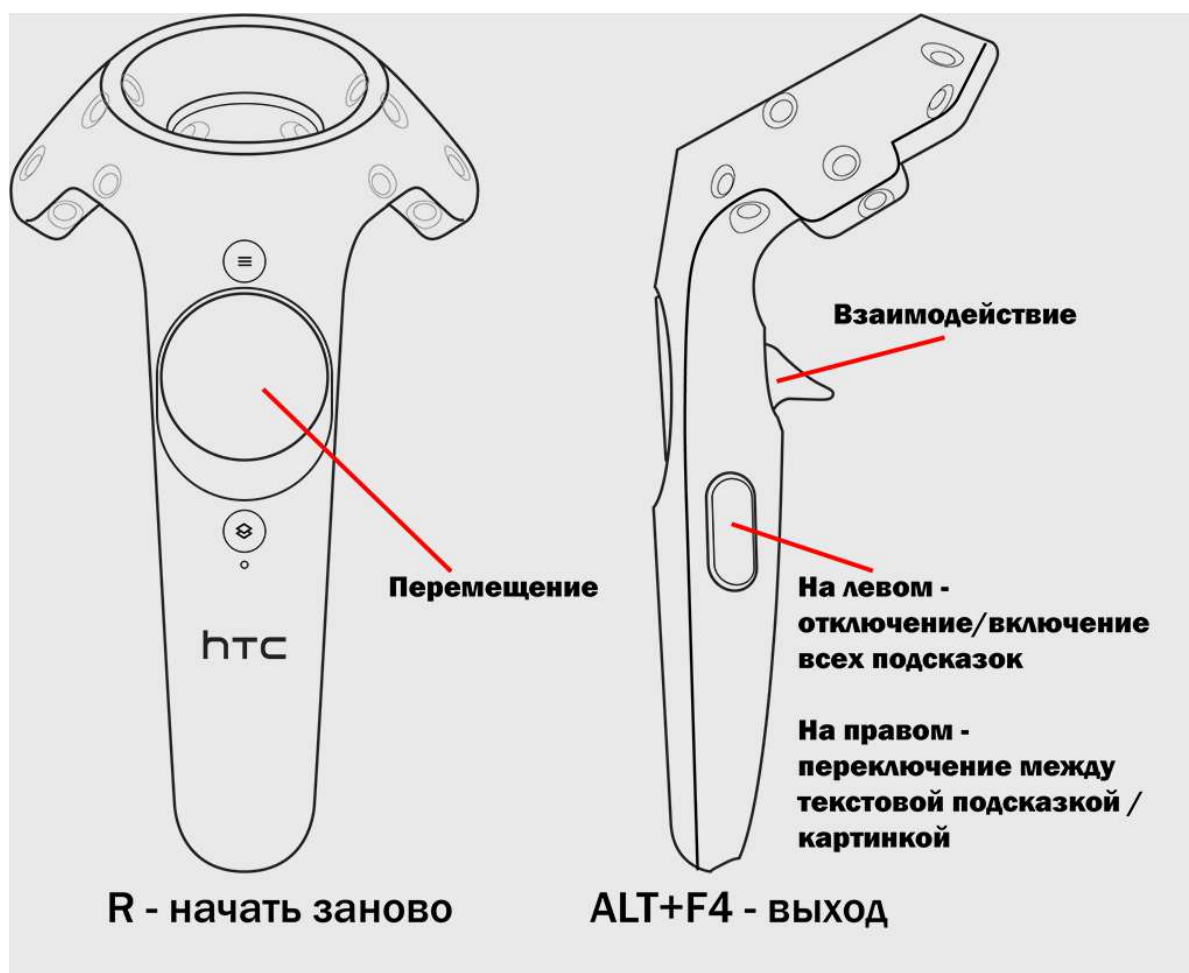
Рис. 62. Управление в виртуальной среде для контроллера системы виртуальной реальности HTC VIVE.
