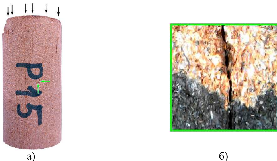
Рисунок 3 – Фотография образца песчаника, предварительно подвергнутого механическому нагружению – а . Черными стрелками отмечены проявления некоторых трещин, возникших при механическом нагружении; зелеными стрелками отмечена область образца, микроскопическая фотография которого приведена на врезке – б
