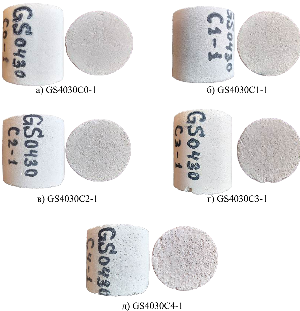
Рисунок 27 – Фотографии гипсовых образцов с примесью песка различных фракций (до нагрева): а) – без примеси, б) – фракция d < 200 мкм, в) – фракция 200 < d < 315 мкм, г) – фракция 315 < d < 400 мкм, д) – фракция 400 < d < 630 мкм. Для каждого образца даны фотографии сбоку и сверху.
