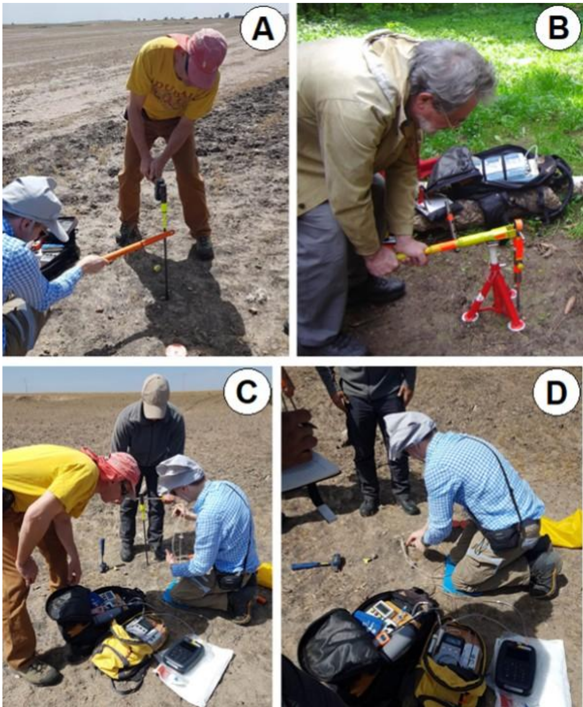
Рис. 9. Методика получения и анализа пробы газа из скважины. А – забивание штыря в землю, В – вытягивание штыря с помощью рычага и телескопической треноги, С – ручное извлечение штыря, подготовка пробоотборника и контроль приборов, Д – установка пробоотборника в скважину, включение циркуляционного насоса и считывание показаний.
