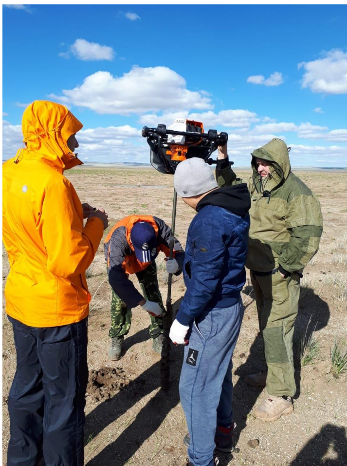
Рис. 12. Отбор проб грунта с помощью мотобура Stihl BT-131 и шнека с удлинителями. Монголия, 2019 г.
