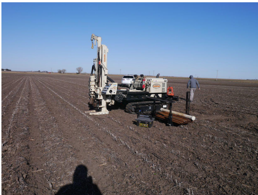
Рис. 13. Гидравлический пробоотборник (direct push) на гусеничном ходу. Небраска, США 2016 год.
