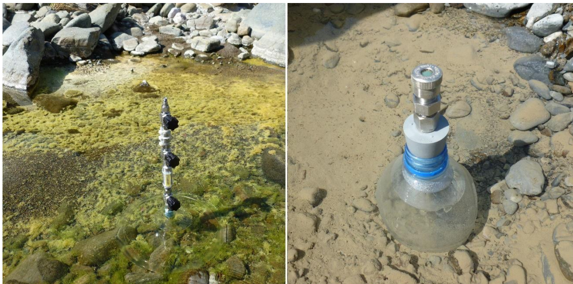
Рис. 11. Пример отбора пузырей с помощью оборудования Swagelok. Слева – воронка с трубками и кранами для отбора пузырей и запираания пробы газа. Справа – устройство с резиновой мембраной для отбора проб с помощью иглы. Оман 2012 год
