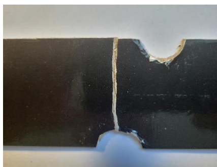
Рисунок 2.12. Фотография разрушенного образца со смещенными выточками.
