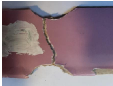
Рисунок 2.4. Фотография разрушенного опытного образца с центрально расположенными выточками.
