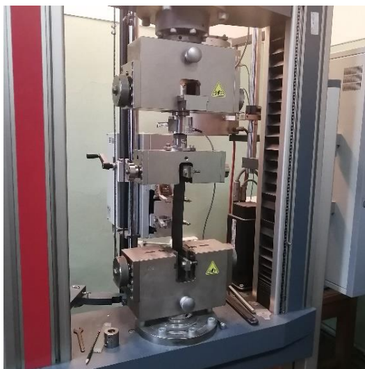
Рисунок 3.15. Фотография установки для проведения испытаний резинокордных образцов.
