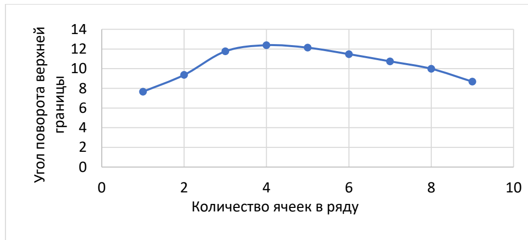
Рисунок 3.22. Зависимость меры связанности растяжения-кручения \beta_2 от числа ячеек периодичности.
