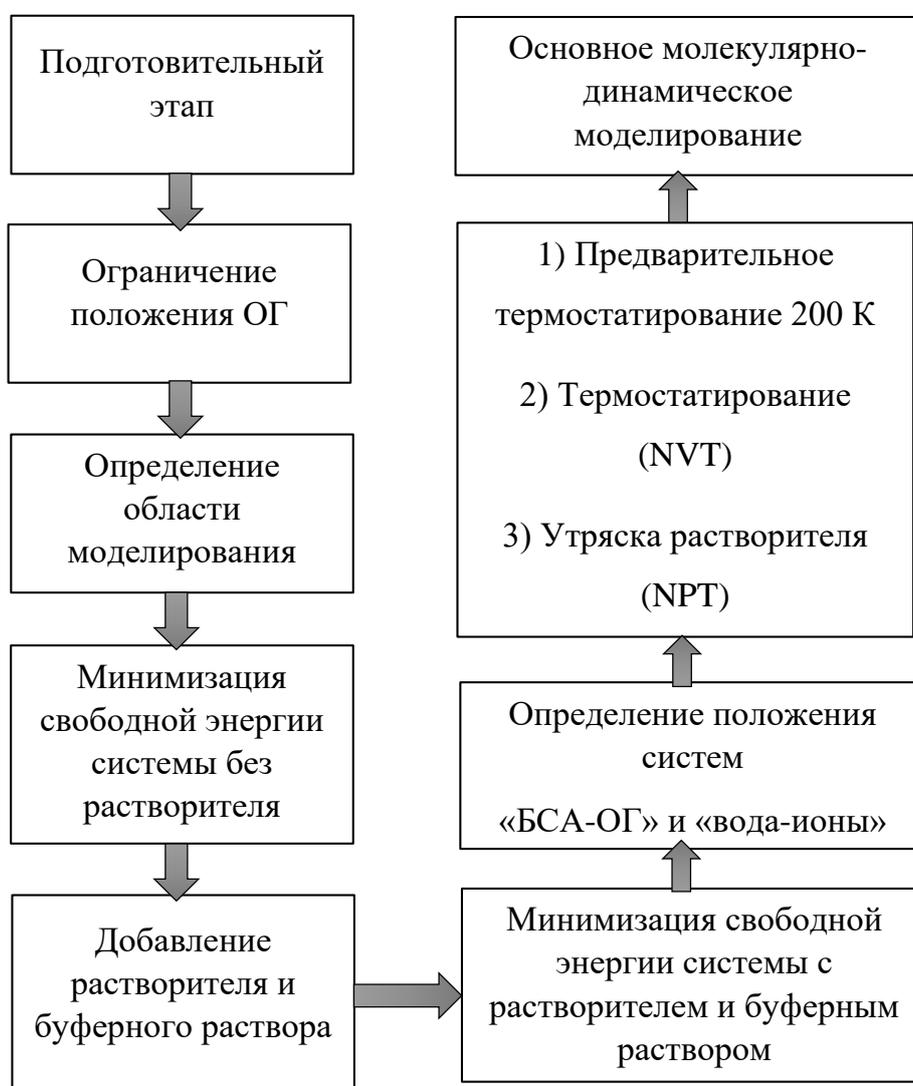
Рисунок 9. Основные этапы проведения компьютерного моделирования по методу молекулярной динамики.
