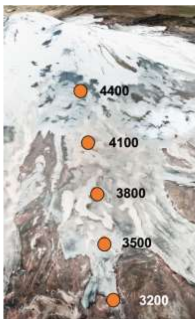
Рисунок 4.5.1. Схема положения расчетных точек на леднике Гарабаши, в качестве подложки использован снимок с ресурса Google Earth [earth.google.com].
