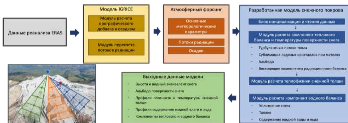
Рисунок 3.1.1. – Общая схема работы модели снежного покрова SnowDraw, ее входных данных и препроцессинга.
