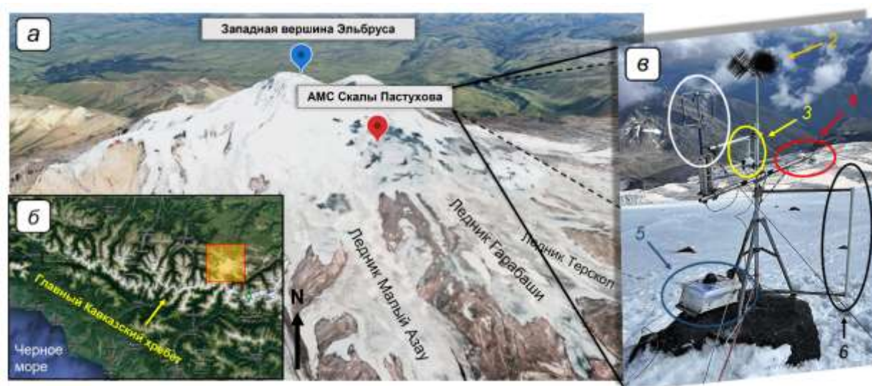
Рисунок 2.2.2. Район исследований (г. Эльбрус) (а) с положением на территории Кавказа (б) и измерительный комплекс в зоне аккумуляции ледника Гарабаши (скалы Пастухова) в 2021-2022 годах (в), где 1 – акустический анемометр Gill, 2 – «грозозащитные ершики», 3 – термогигрометр Rotronic, 4 – балансомер HukseFlux, 5 – ящик с логгером Campbell и устройством мобильной передачи данных, 6 – акустический метелемер ISAW FlowCapt4. Пунксионами показаны: «АМС Скалы Пастухова» – измерительный полигон (высота 4720 м. над у. м.) и западная вершина вулкана Эльбрус (5642 м. над у. м.). Для создания данного рисунка использованы материалы Google Earth [earth.google.com].
