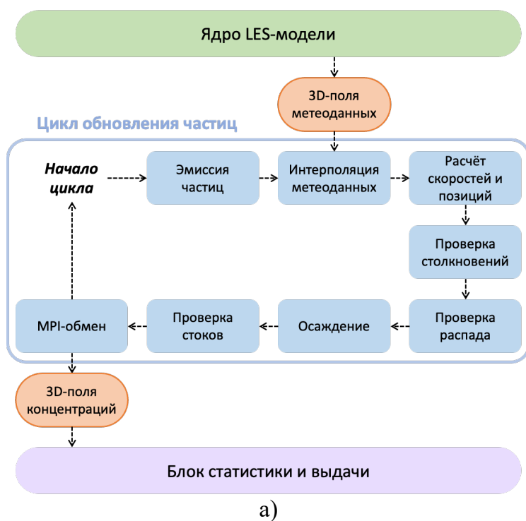
Рисунок 2 – Алгоритм работы модуля лагранжева переноса частиц в LES-модели НИВЦ МГУ и ИВМ РАН (а). Комплекс для измерения концентраций частиц в полупустыне, п. Нарын-Худук, Калмыкия (б). Профили концентрации песчаных по эмпирическим профилям (аппроксимация данных измерений) и расчётам лагранжевой модели (в).
